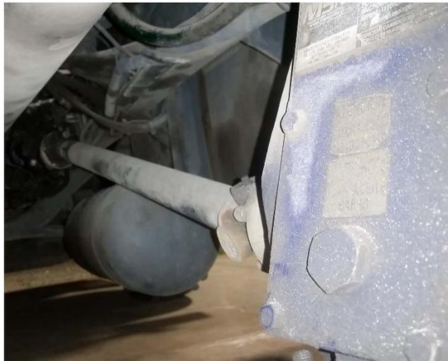
Figura 4- 8 Montaje multiplicador de RPM
