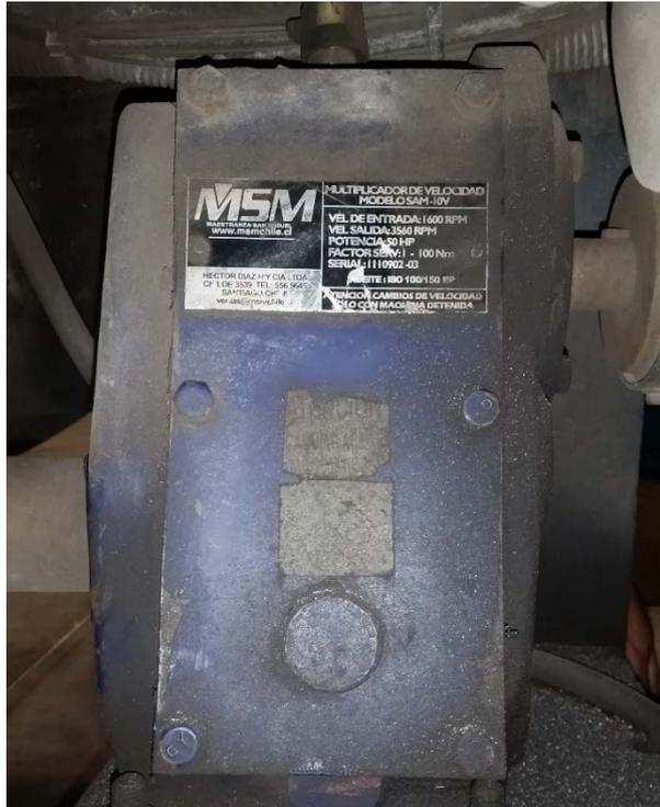
Figura 4- 9 Multiplicador de RPM
