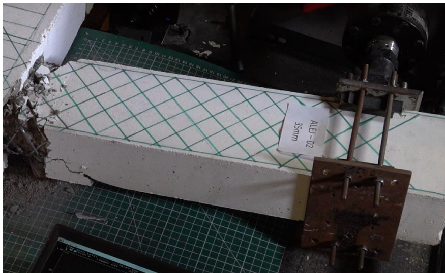
Figura 62: Salida de riel hacia sector del actuador, ALEJ-2 primer ciclo 35 [mm]
