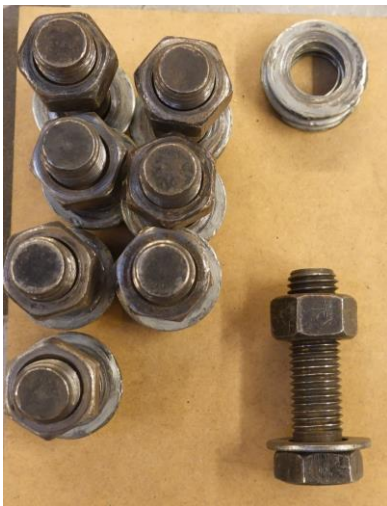
Figura 110: Pernos de fijación del zapato de apoyo junto a bolillas
