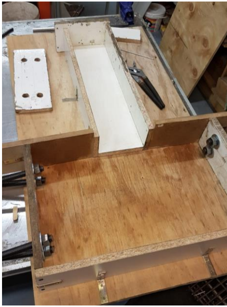
Figura 31: Moldaje Espécimen Finalizado
