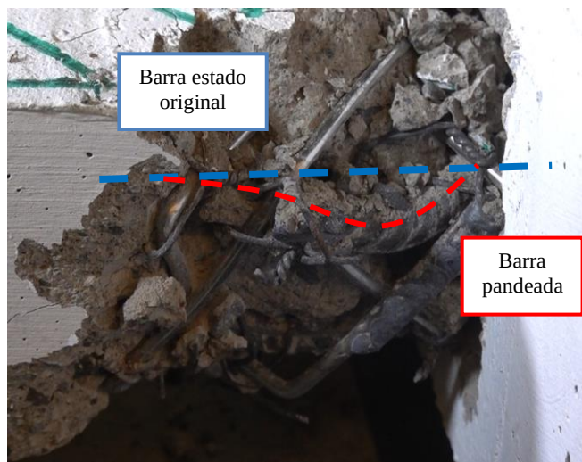
Figura 50: Máximo pandeo refuerzo longitudinal, primer ciclo de 35 [mm]
