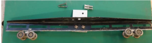
Figura 113: Carro con configuración ALEJ-2 de ruedas
