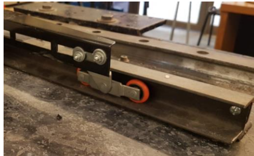
Figura 114: Configuración ruedas para ALEJ-1
