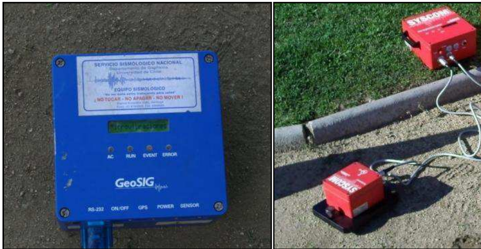
Ilustración 8: Geófono GVB 316 y SYSCOM MR 2002 respectivamente
