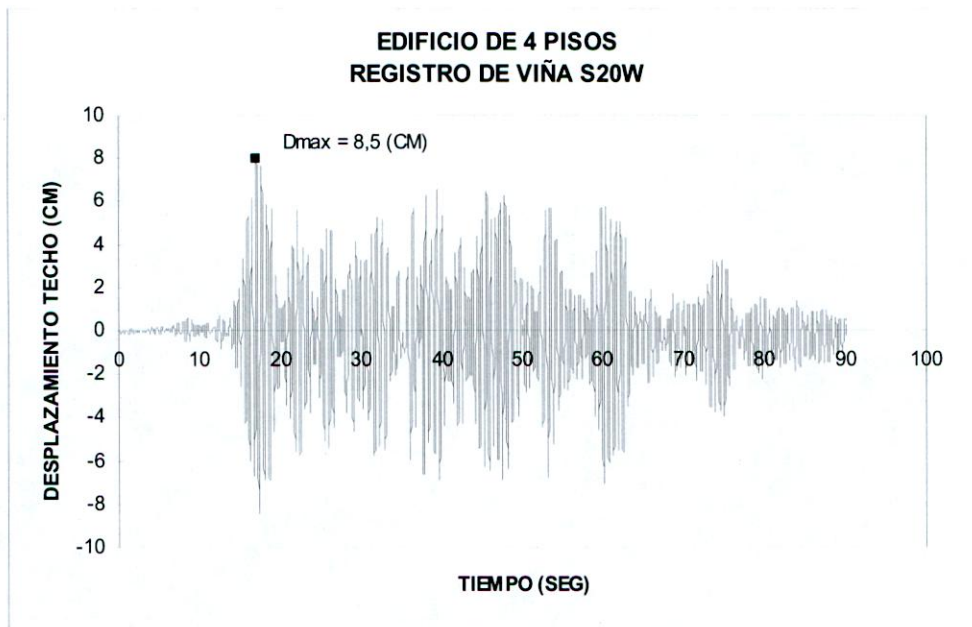
Figura A.1.2: Desplazamiento de techo v/s tiempo
