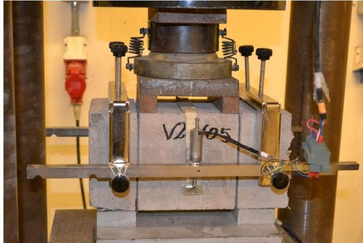
Figura 4: Disposición según norma JSCE-SF6 modificado.
