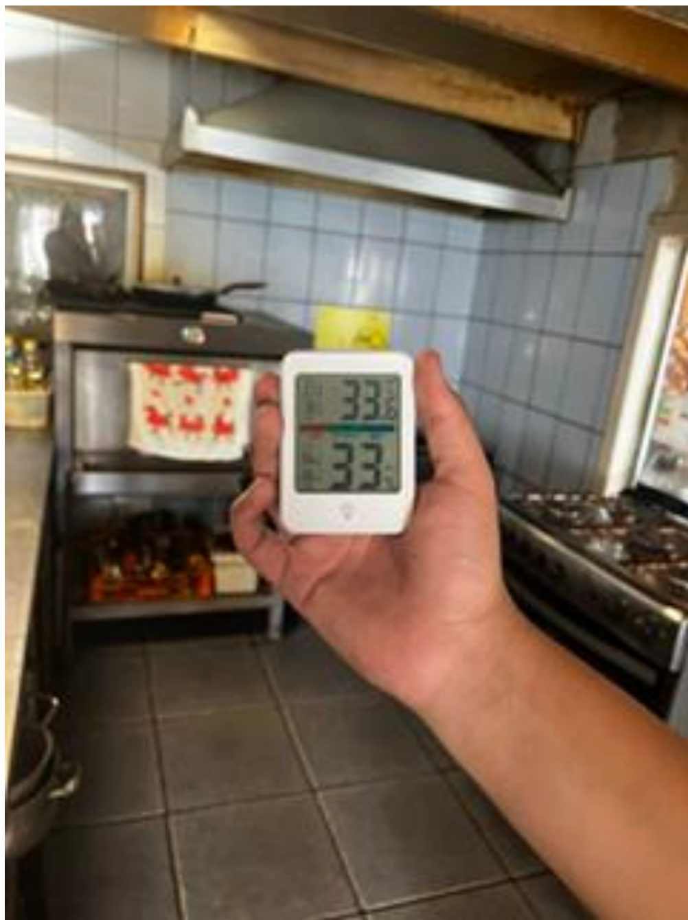
ILUSTRACIÓN 40: MEDICIÓN DE TEMPERATURA INTERIOR Y HUMEDAD RELATIVA EN SECTOR COCINA
