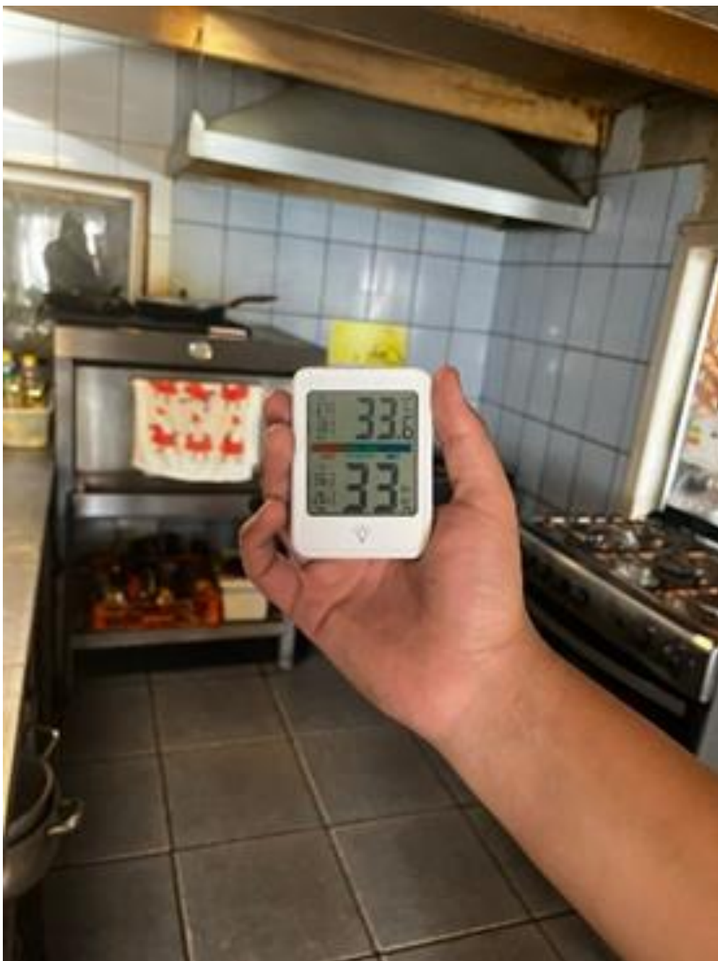
ILUSTRACIÓN 20: MEDICIÓN DE TEMPERATURA Y HUMEDAD RELATIVA EN SECTOR COCINA DEL RESTAURANTE, EVIDENCIANDO MEDICIONES MUY POR SOBRE EL RANGO PERMITIDO.
