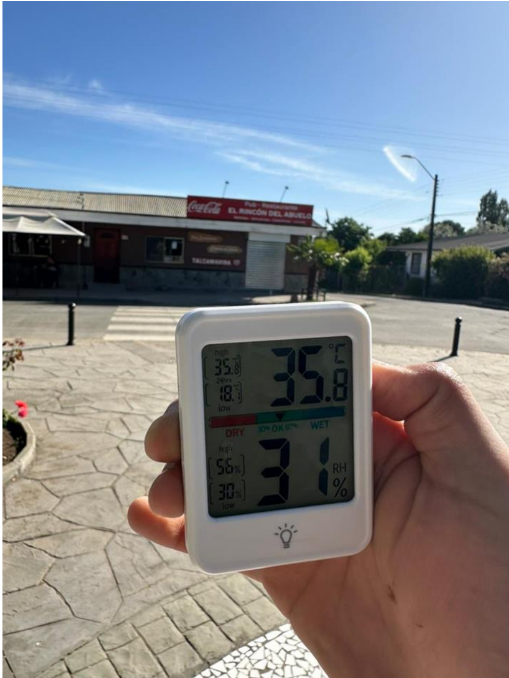
ILUSTRACIÓN 33: INSTRUMENTO QUE MIDE TEMPERATURAS Y HUMEDADES INTERIORES Y EXTERIORES DEL RESTAURANTE.
