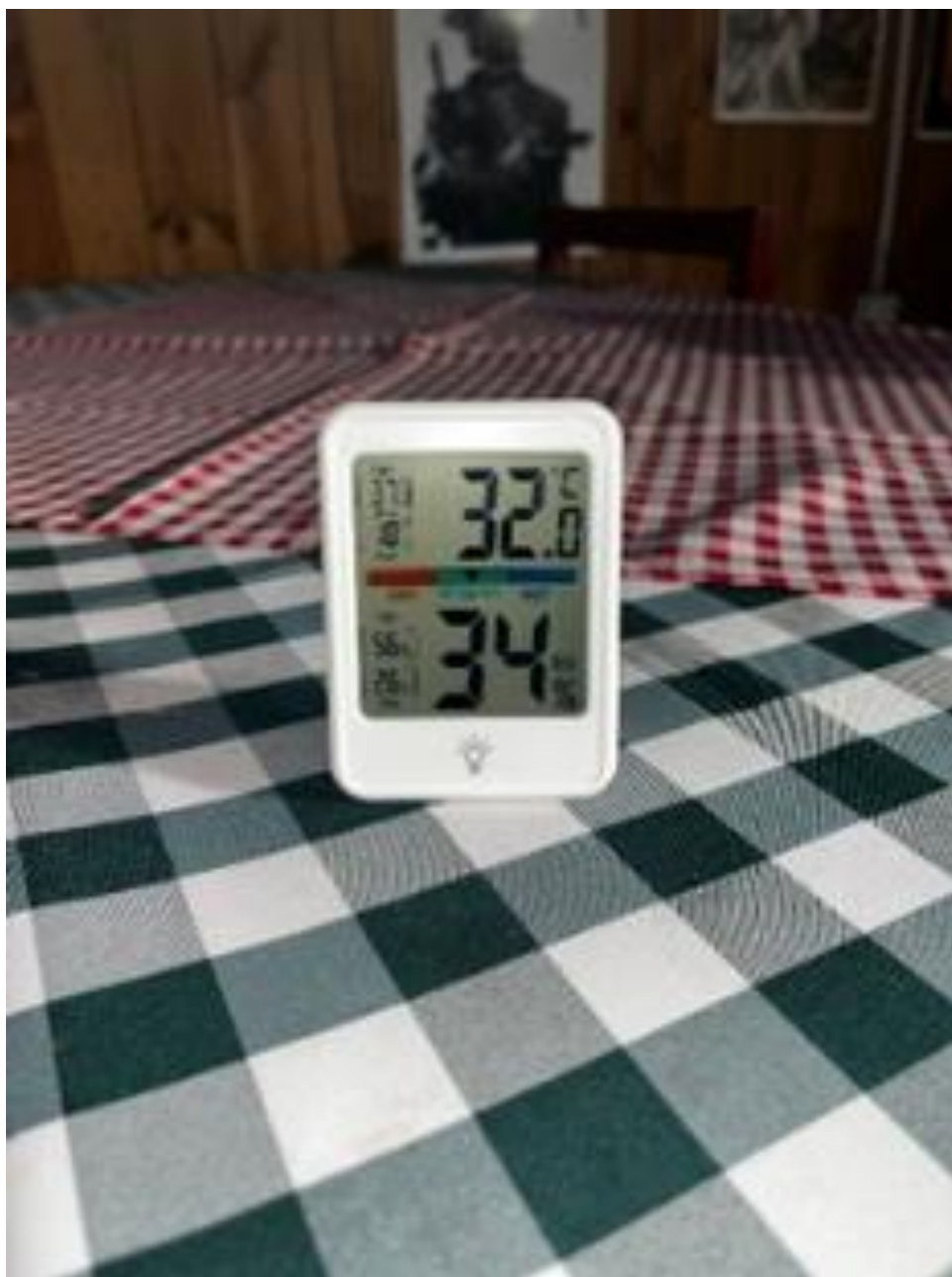
ILUSTRACIÓN 21: MEDICIÓN DE TEMPERATURA Y HUMEDAD RELATIVA EN EL COMEDOR NÚMERO 2 DEL RECINTO, EVIDENCIANDO 32°C DE TEMPERATURA INTERIOR EL CUAL ESTÁ MUY POR SOBRE LOS RANGOS ESTABLECIDOS.
