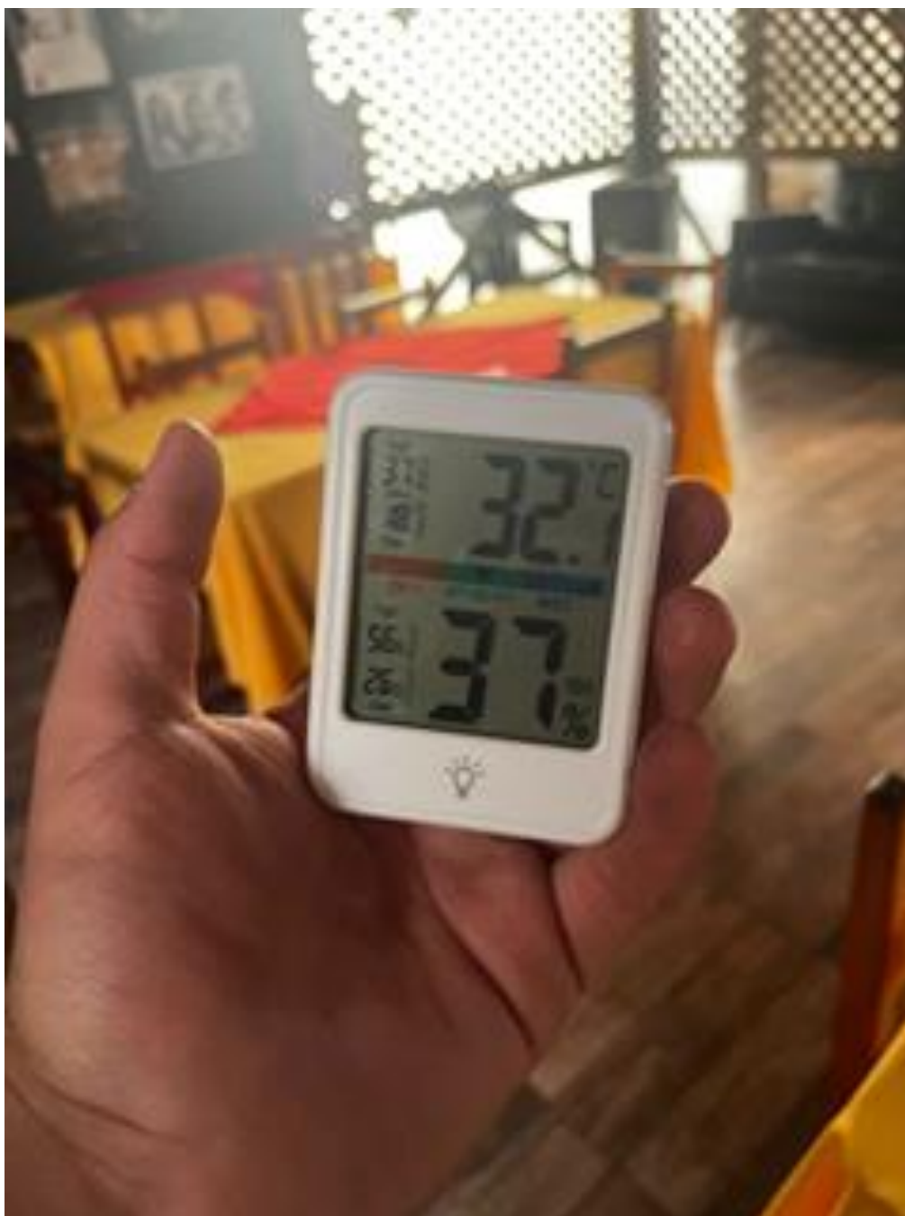
ILUSTRACIÓN 41: TEMPERATURA INTERIOR COMEDOR CLIENTES "TERRAZA 3" Y HUMEDAD RELATIVA MUY POR SOBRE RANGOS ÓPTIMOS MEDIANTE TERMOHIGRÓMETRO.
