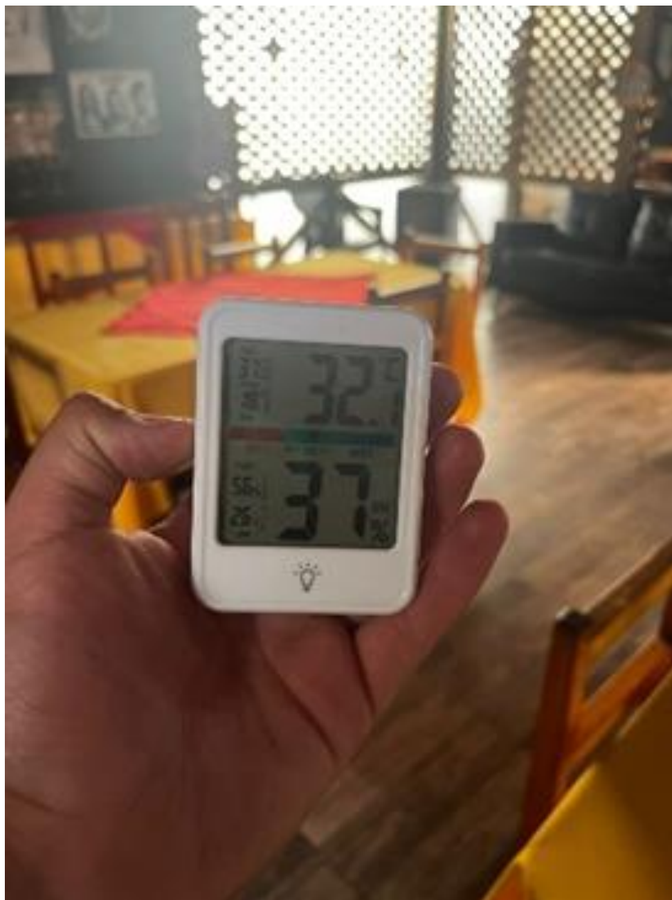
ILUSTRACIÓN 19: MEDICIÓN DE TEMPERATURA Y HUMEDAD RELATIVA EN EL COMEDOR NÚMERO 3 DEL RECINTO, DONDE EVIDENCIA GRAVES PROBLEMAS DE CONFORT TÉRMICOS
