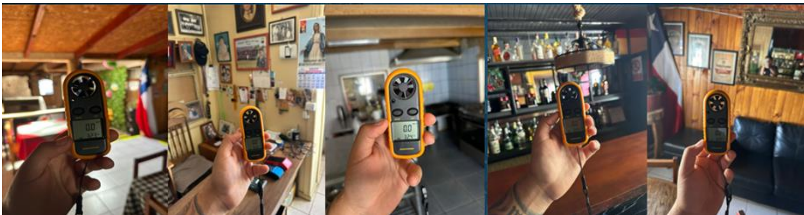
ILUSTRACIÓN 43: MEDICIÓN DE VELOCIDAD DE AIRE MEDIANTE ANEMÓMETRO EN SECTOR COMEDORES, COCINA, BAR DEL RESTAURANTE EVIDENCIANDO UN AMBIENTE SOFOCANTE YA QUE NO CIRCULA AIRE.
