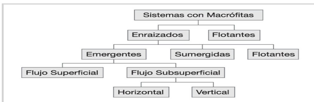
Figura 7. Esquema de distintos tipos de Humedales construidos, extraído de Delgadillo et al. , 2010.
