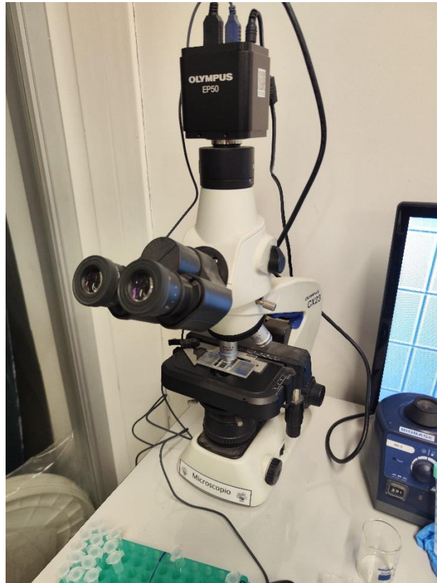
Figura 3.4. Microscopio Olympus CX23 y cámara Neubauer usada para el recuento directo de bacterias
