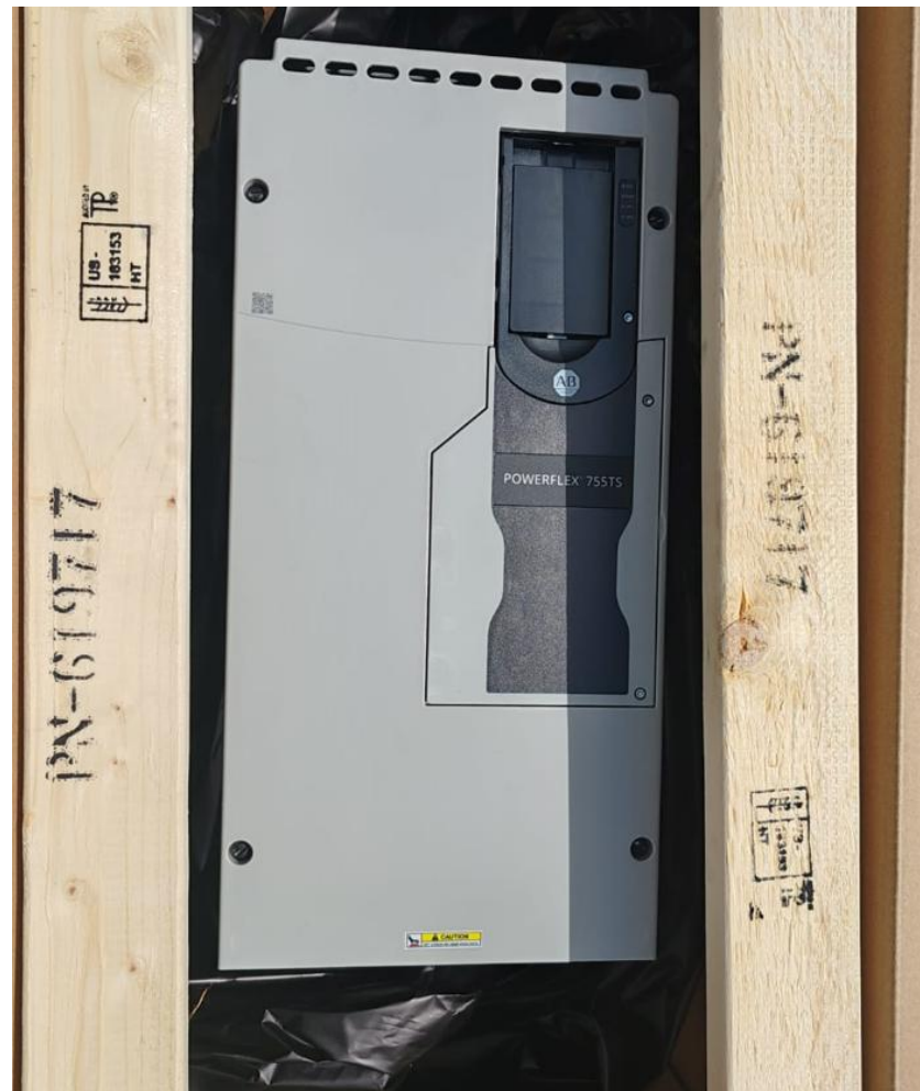
Figura 9. Variador de frecuencia PowerFlex 755TS.
