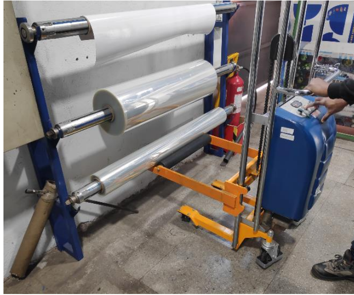
Figura 30. Elevador de rollos y estación de precarga de bobinas.
