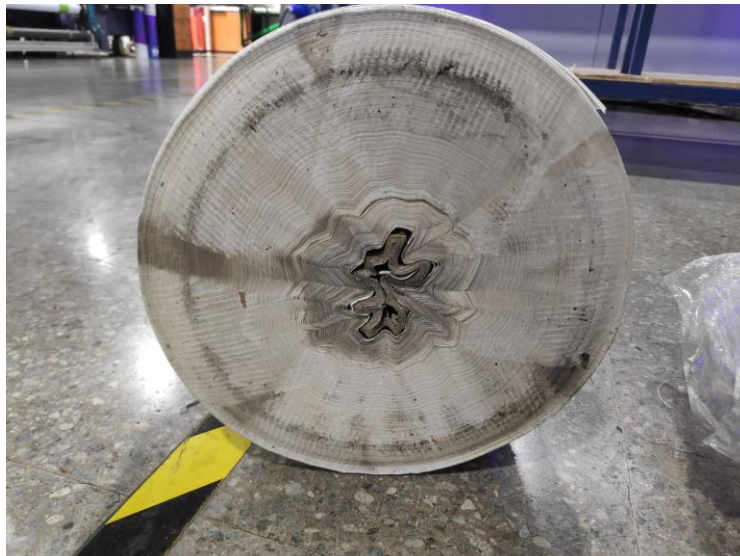
Figura 26. Bobina de PVC dañada por agua.
