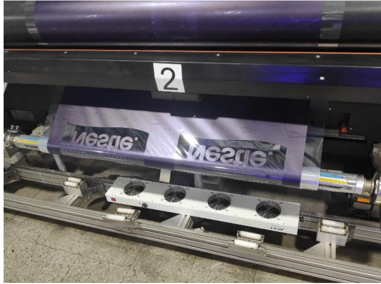
Figura 31. Ionizador de aire colocado bajo la bobina.
