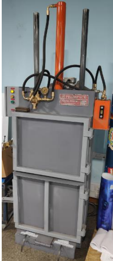
Figura 38. Compactador de basura.
