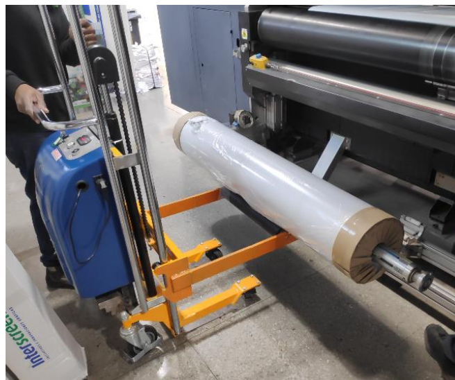
Figura 29. Elevador de rollos cargando impresora.
