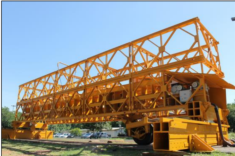
Figura 2-13. Ensayo de simulación de tráfico a escala real desarrollado por la Universidad Federal de Río de Janeiro, Brasil [22] .
