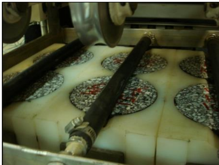
Figura 2-14. Preparación de la cinta de caucho presurizada y probetas en ensayo APA.
