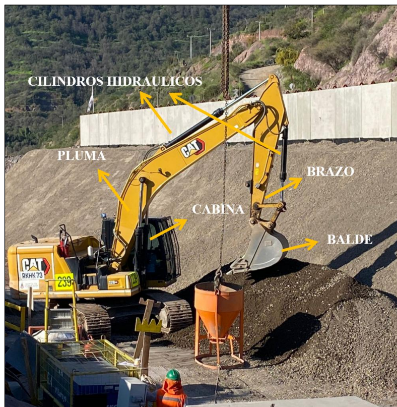
Figura 2-5 Principales componentes excavadora.
