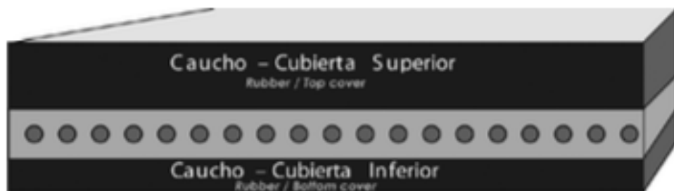
Figura 2. Perfil de una correa con núcleo de acero.
