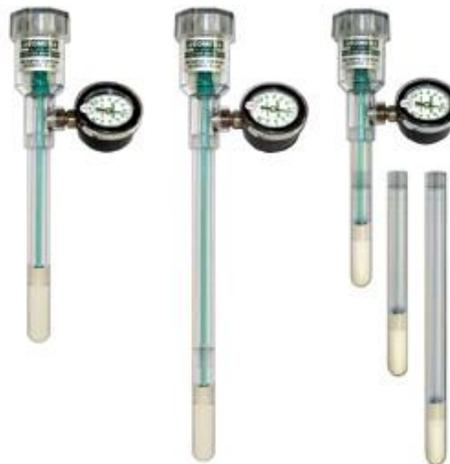
**Figura 4-2: Tensiómetros modelo Irrrometer.**
