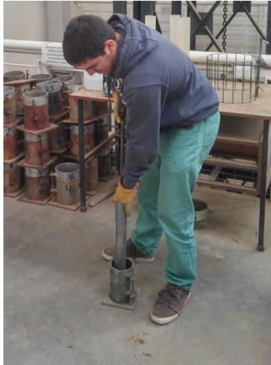
**Figura 10-12: Ensayo Proctor estándar.**
