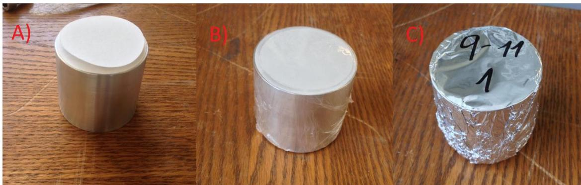
**Figura 6-10: Proceso de colocación de papel filtro.**
