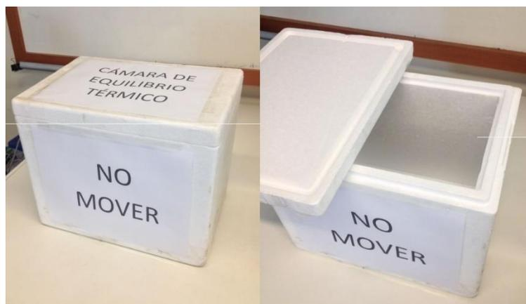
**Figura 6-8: Cámara de equilibrio térmico utilizada para el método de papel filtro.**
