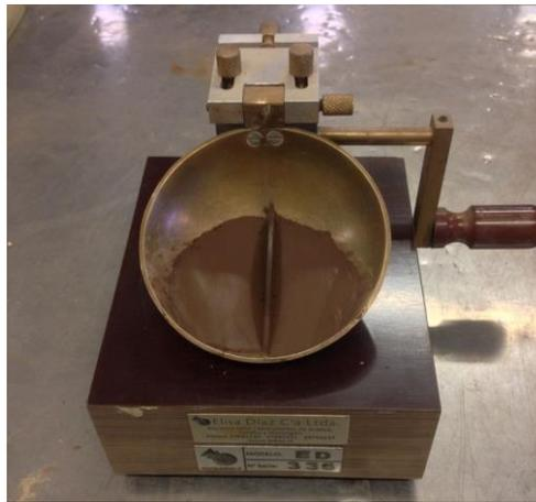
**Figura 10-10: Ensayo límite líquido con cuchara de Casagrande.**
