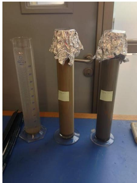
**Figura 10-13: Ensayo granulometría por sedimentación, método del hidrómetro.**
