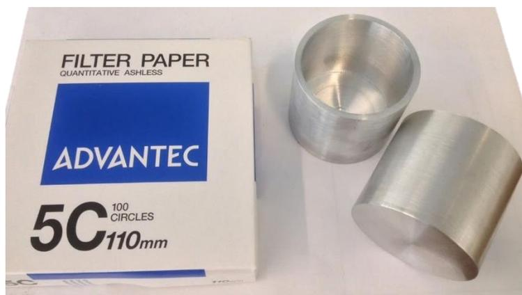
**Figura 6-7: Papel filtro sin cenizas equivalente a Whatman 42 y contenedores para método indirecto de papel filtro.**
