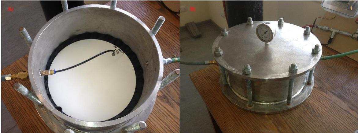
**Figura 6-1: Cámara de presión con plato cerámico poroso.**
