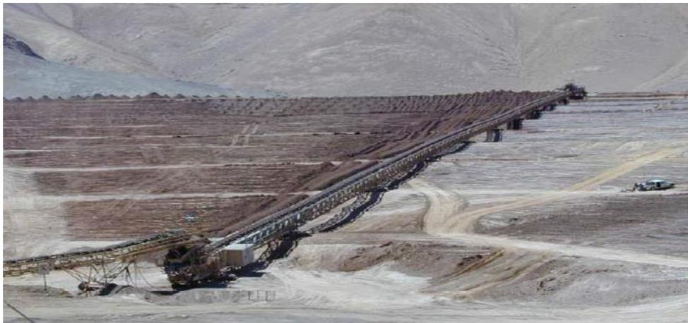
**Figura 5-5: Depósito de relaves filtrados.**
