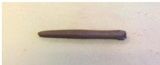
**Figura 10-11: Ensayo límite plástico.**
