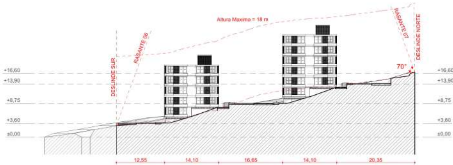
Figura 20: Elevación Oriente Conjunto Habitacional.
