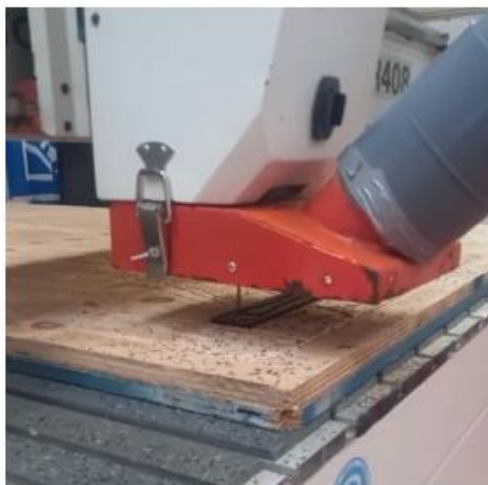
Figura 92: Mecanización de placas a través de fresadora CNC TigerTec TP408 para obtención de probetas.
