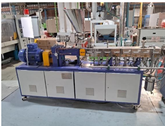
Figura 84: Extrusora Kerke KTE-25D para peletizado de nanocompuesto.
