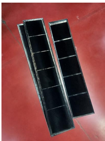
Figura 98: Placas de nanocompuesto con decapado laser.
