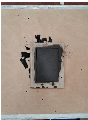
Figura 90: Placa de nanocompuesto generada por compactación en molde inicial de 12×8[cm].
