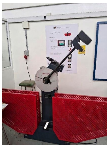
Figura 94: Ensayo de tenacidad (impacto Charpy) sobre probeta de HDPE realizado en equipo TIME JB-300WA.
