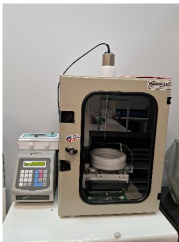
Figura 79: Equipo sonicador Cole Parmer GEX-750 para dispersión de MWCNTs en nanocompuesto.
