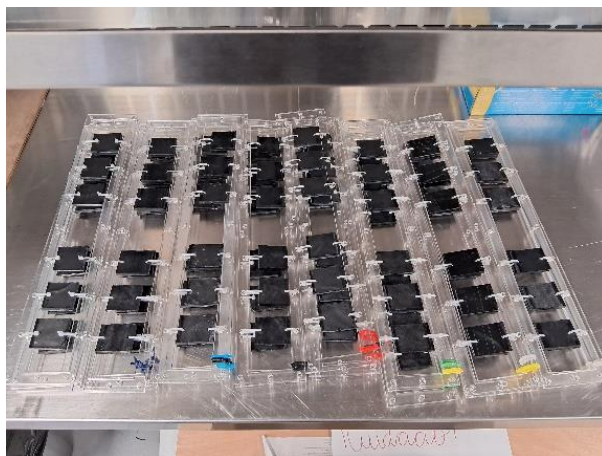
Figura 99: Placas de nanocompuesto montadas en bastidores para ensayo antibiofouling.
