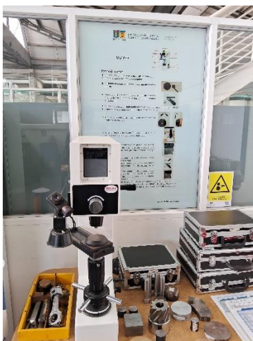
Figura 95: Durómetro Universal Meldic TH722 empleado para ensayos de dureza.
