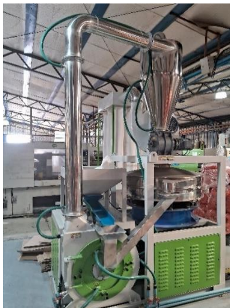
Figura 77: Pulverizador industrial SMF-600 para reducción de HDPE peletizado.
