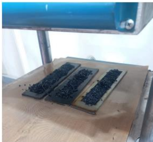
Figura 91: Compactación de nanocompuesto en formato pélet.
