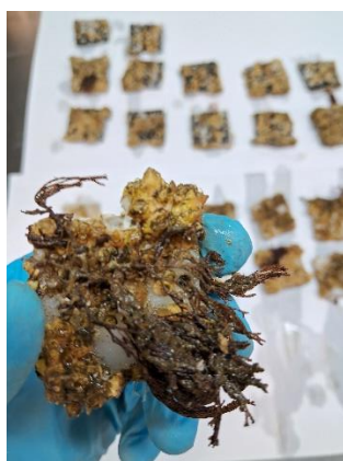
Figura 127: Probetas descartadas de ensayo antibiofouling en Molo de Abrigo realizado entre noviembre 2025 y mayo 2026 (verano-otoño).
