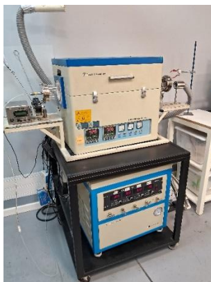
Figura 75: Horno CVD del Laboratorio de Nanobiomateriales.
