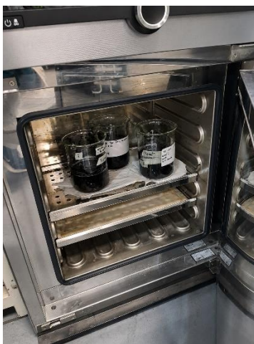
Figura 81: Tanda de MWCNTs/agua desionizada ingresando a estufa Memmert UN55 luego de sonicación.
