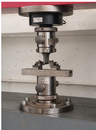
Figura 93: Ensayo de flexión de 3 puntos sobre probeta de nanocompuesto realizado en equipo Zwick Roell Pro Line.
