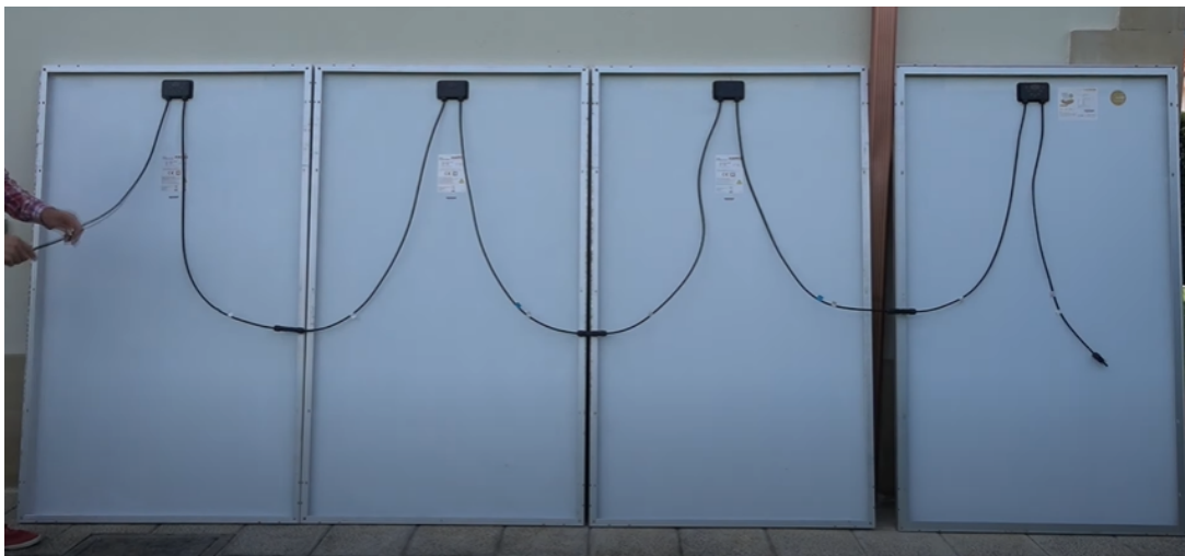
Figura 5.9: Conexión paneles en serie. Fuente: Solar fácil.
