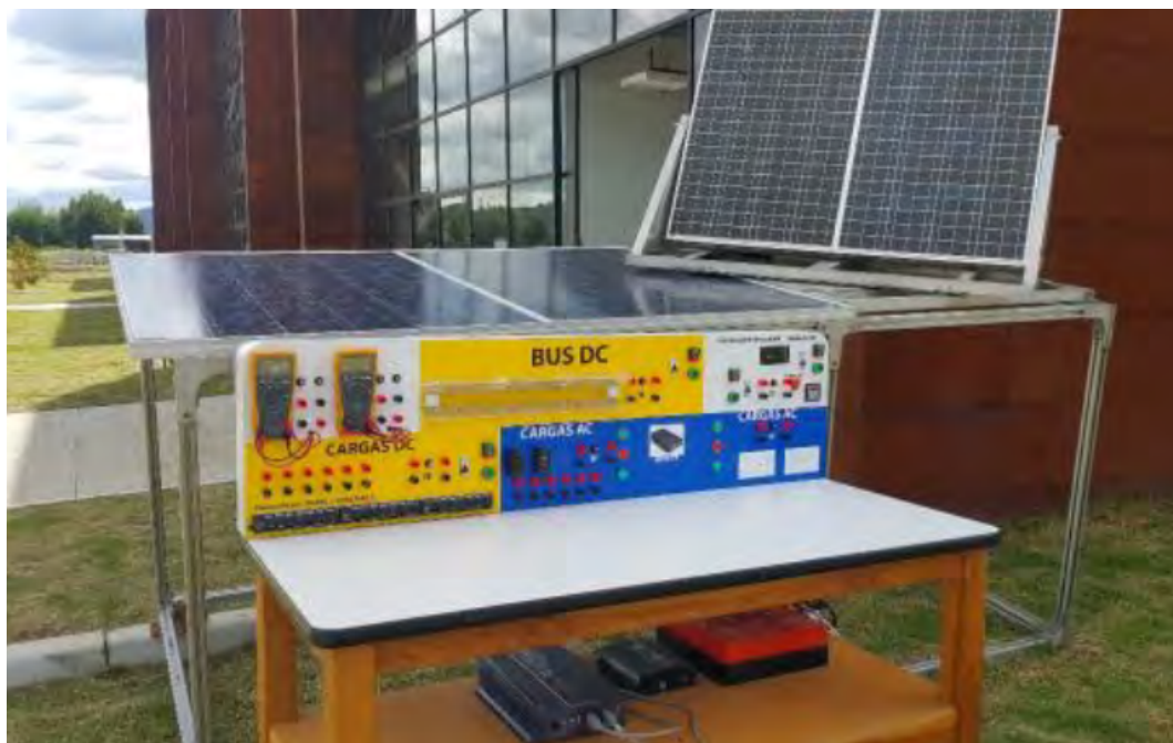
Figura 5.14: Ejemplo de banco y maquetas laboratorio fotovoltaico. Fuente: (Ruiz et al., 2019).
