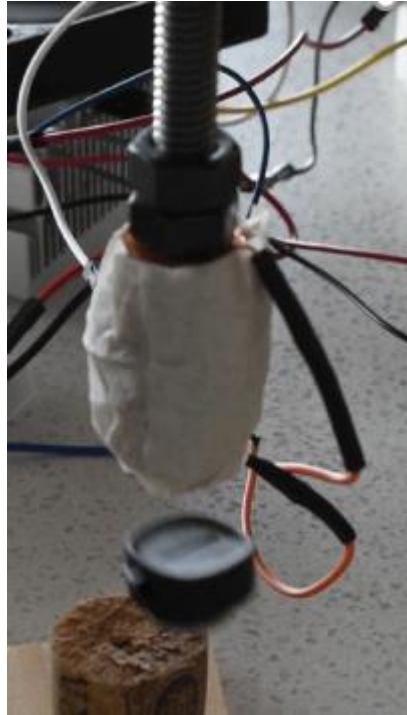
Figura 26: Electroimán atrayendo un imán permanente.
