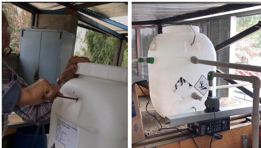
**Figura 22:** Ilustración del tanque durante y finalizado el proceso de inserción de entradas respectivamente.
