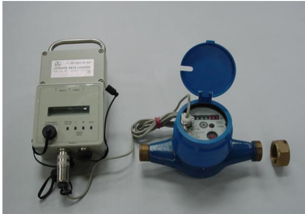
Medidor DN 13 mm con registro cobre-vidrio equipado con Pulser Reed. Se muestra conectado a un Cosmos Data Logger para registro de Perfiles de Consumo. Nótese además las roscas diferenciadas (opcionales).
