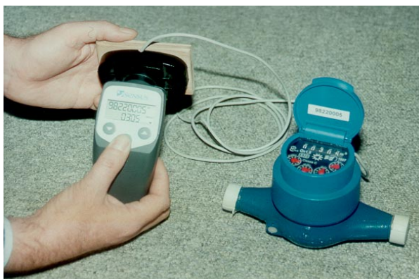
Medidor DN 13 mm con Registro Electrónico Opto-Encoder. Se muestra conectado a un sistema simple de lectura inductiva TouchRead (Protocolo Sensus), consistente en un contacto inductivo de pared (WallPad) y un capturador inductivo simple de datos (TouchReader). Longitud máxima del cable hasta 30 m.
