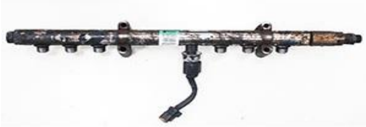
Figura 1- 3 riel de combustible.
