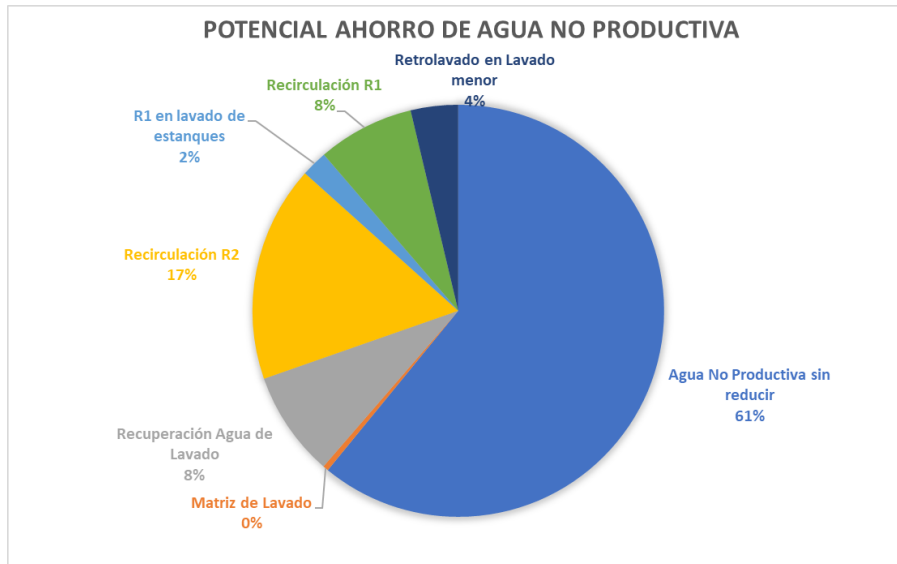
Figura 25. Potencial ahorro de agua no productiva al implementar las acciones correctivas de disminución de agua.
