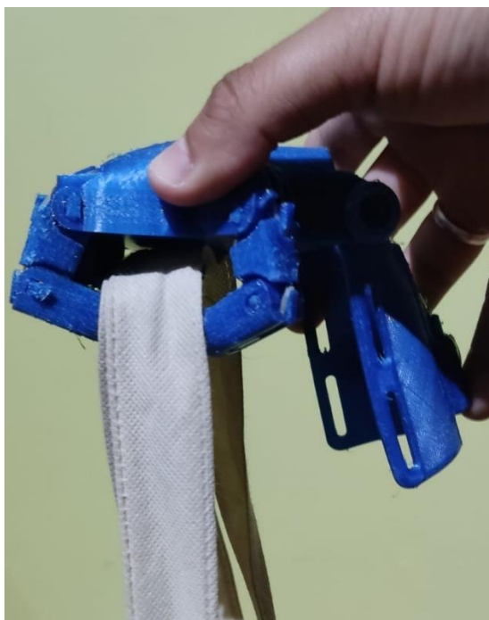
Fuente: Prótesis en agarre sometida a carga real
