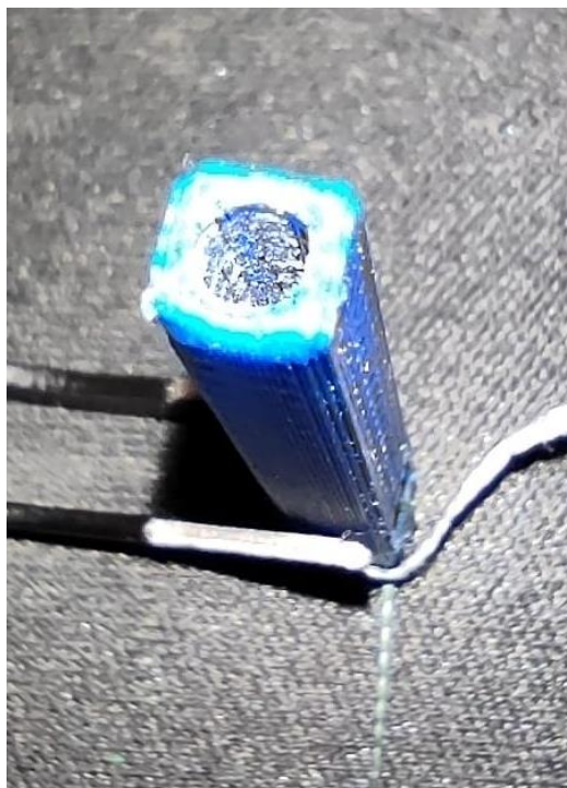
Figura 3.32. Desgaste de Tensor PLA.
