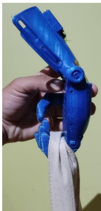
Fuente: Prótesis en agarre sometida a carga real
