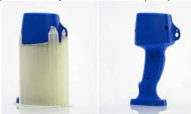
Figura 1.5. HIPS y su función como soporte para ABS
