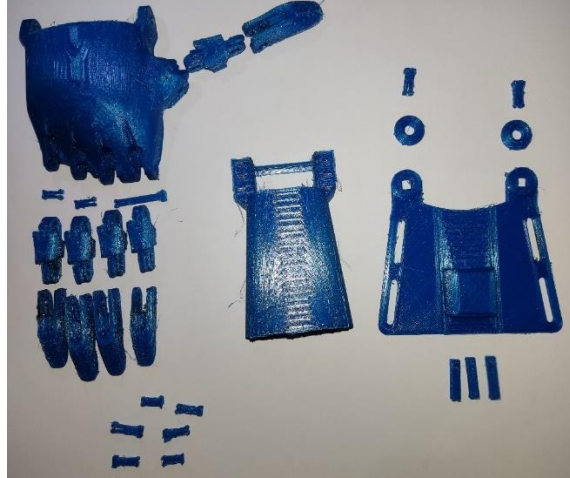
Figura 3.12. Componentes impresos de prótesis de muñeca.
