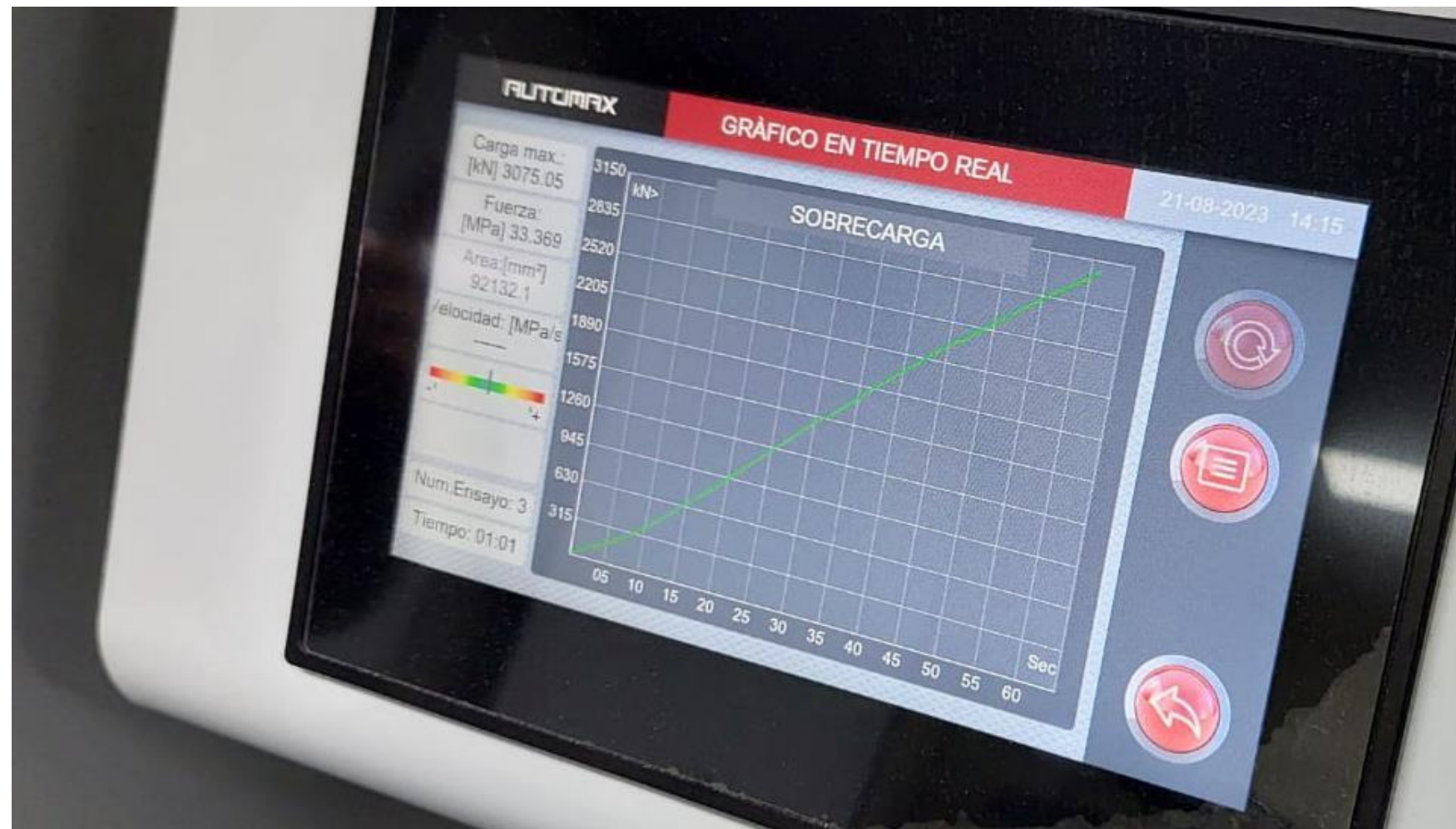
Figura 44: : Ensayo de compresión en pastelón original
