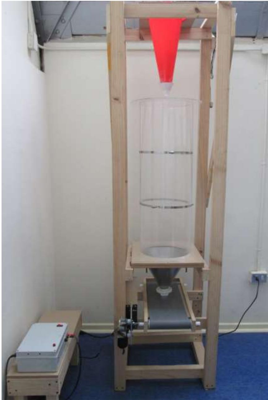
Figura 16: Montaje del modelo físico construido con tolva de 30°.
