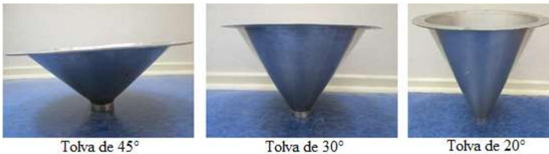
Figura 14: Tolvas cónicas de diferentes ángulos de inclinación.
