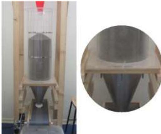
Figura 20: Visualización del material en el silo para determinar el tipo de flujo desarrollado.
