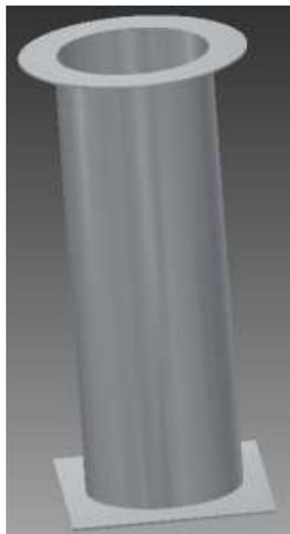
Figura 9: Diseño de sección vertical del silo mediante Inventor.
