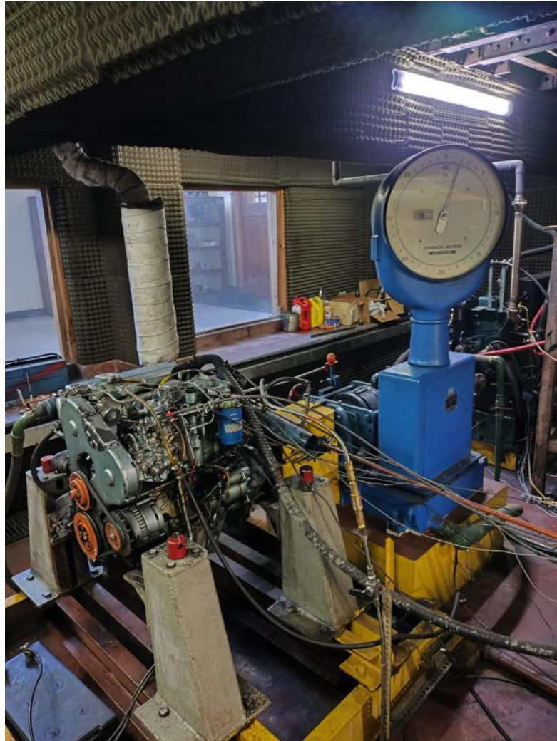
Figura 6. Motor Instalado con Freno Dinamométrico
