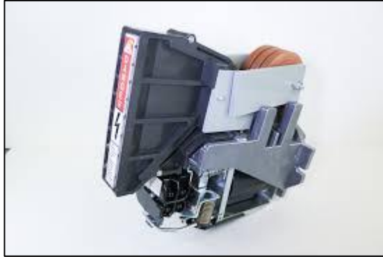
Ilustración 16 "Contactor Komatsu 930" Fuente: Shop Manual 930E
