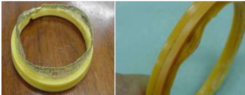
Fuente:www.gos.com Sellos en mal estado
