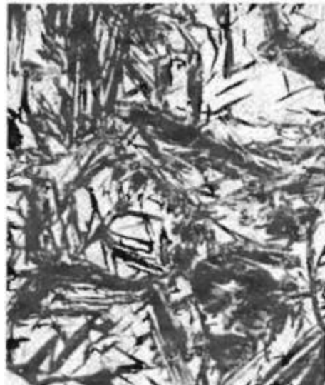
Figura 1-1 Fotomicrografía de un acero con microestructura martensítica (Callister, 2000).
