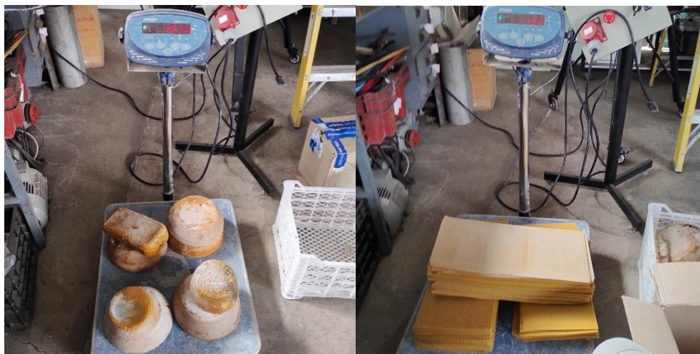
Imagen 14: Ceras masadas para limpiar. Izquierda: masa de cera no laminada, derecha: masa de cera laminada Fotografías propias.
