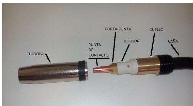
Figura.1.5.1: Partes pistola.
