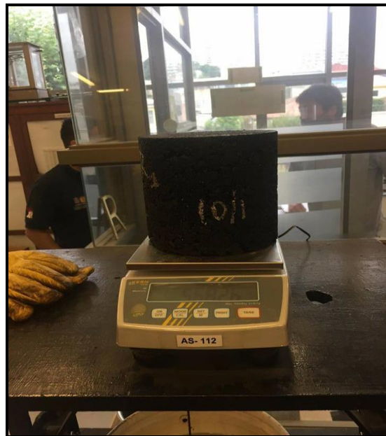
Imagen 6-13 Peso en seco de la probeta
