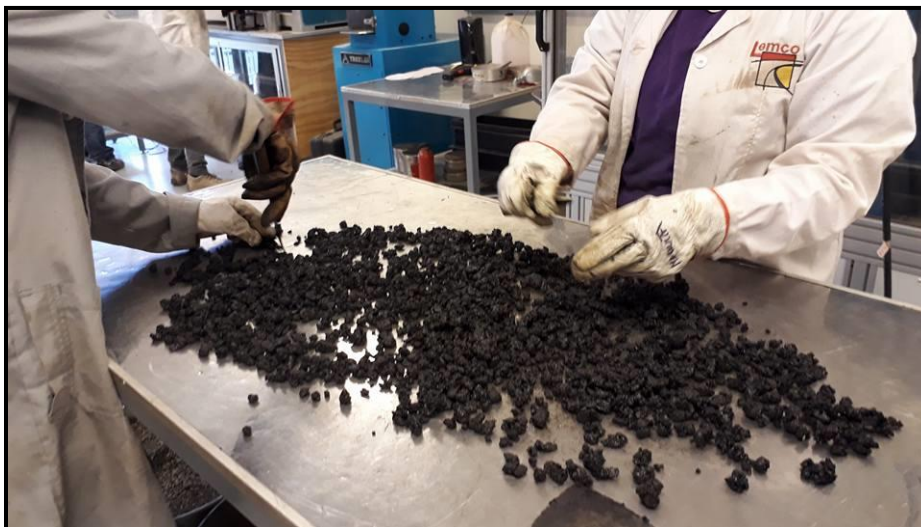
Imagen 6-16 Separación de las partículas recubiertas de asfalto para la determinación del Gmm
