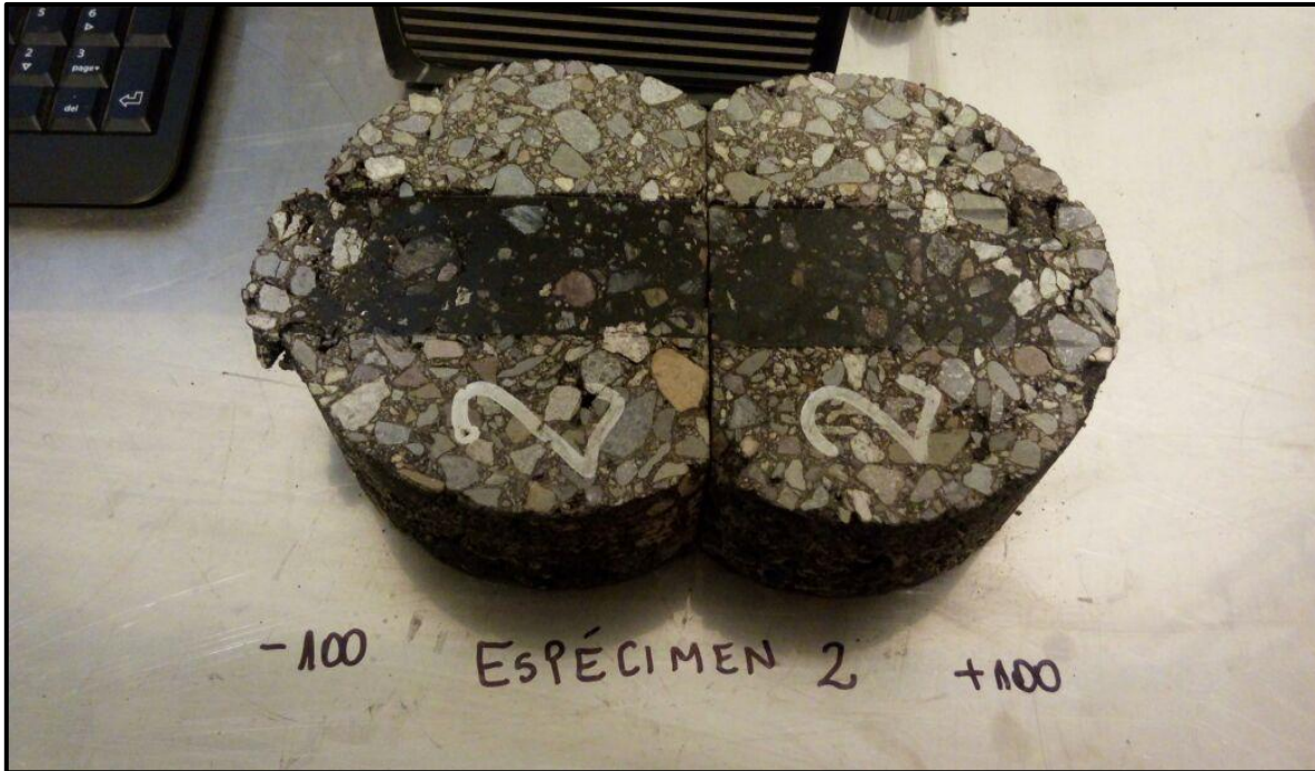
Imagen 6-18 Probeta 2 sometida a las ruedas de carga por la máquina de Hamburgo
