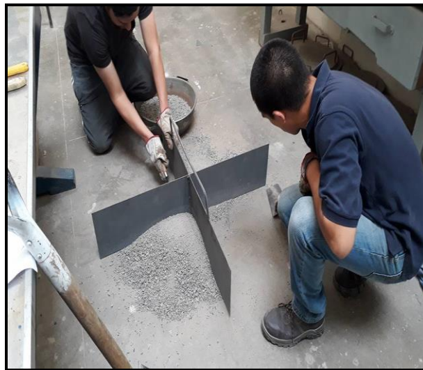
Imagen 6-4 Remoción de dos cuartas partes del árido
