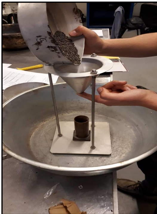
Imagen 6-6 Procedimiento de vertido del árido fino
