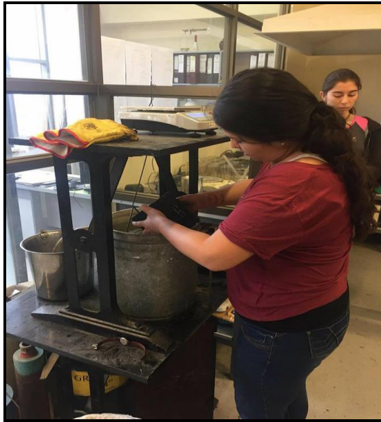
Imagen 6-14 Peso de la probeta sumergida en agua
