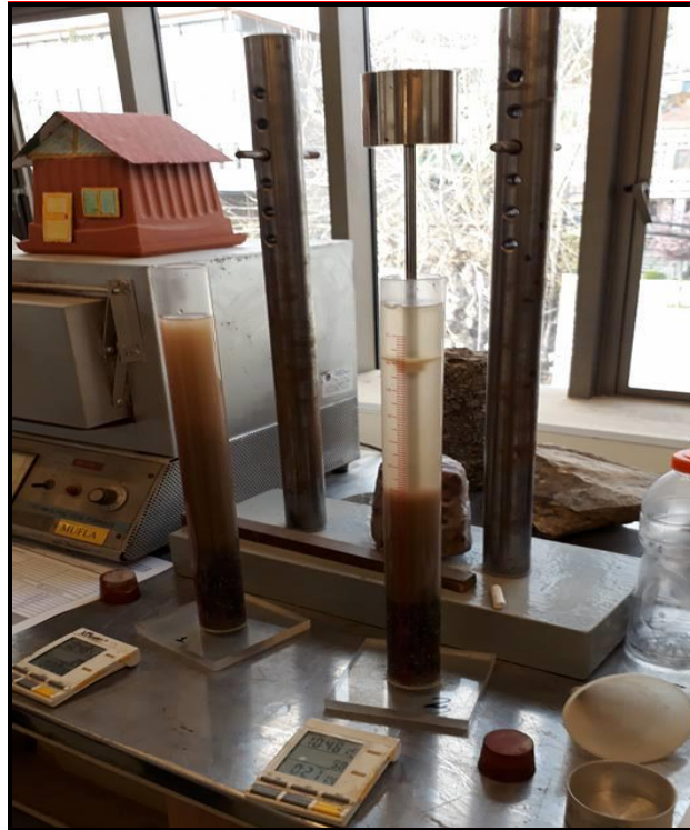
Imagen 6-9 Pisón dentro de la probeta de ensaye
