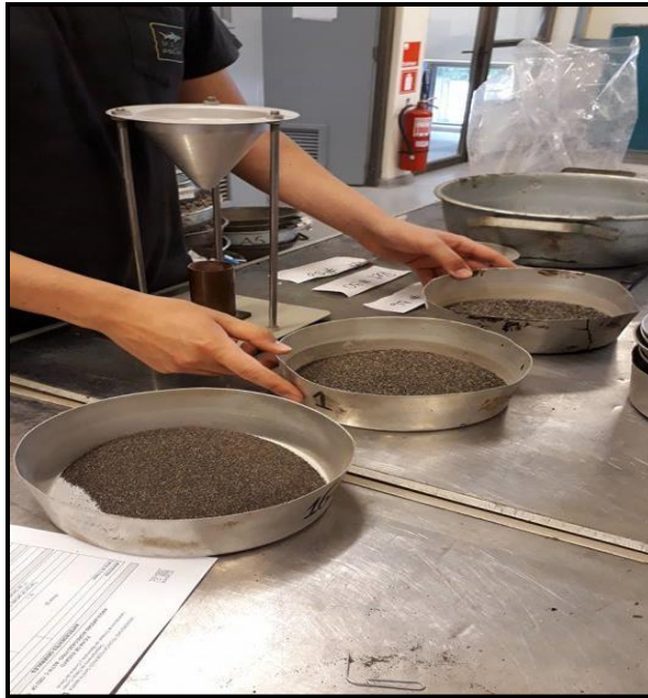
Imagen 6-5 Distribución del árido por tamices
