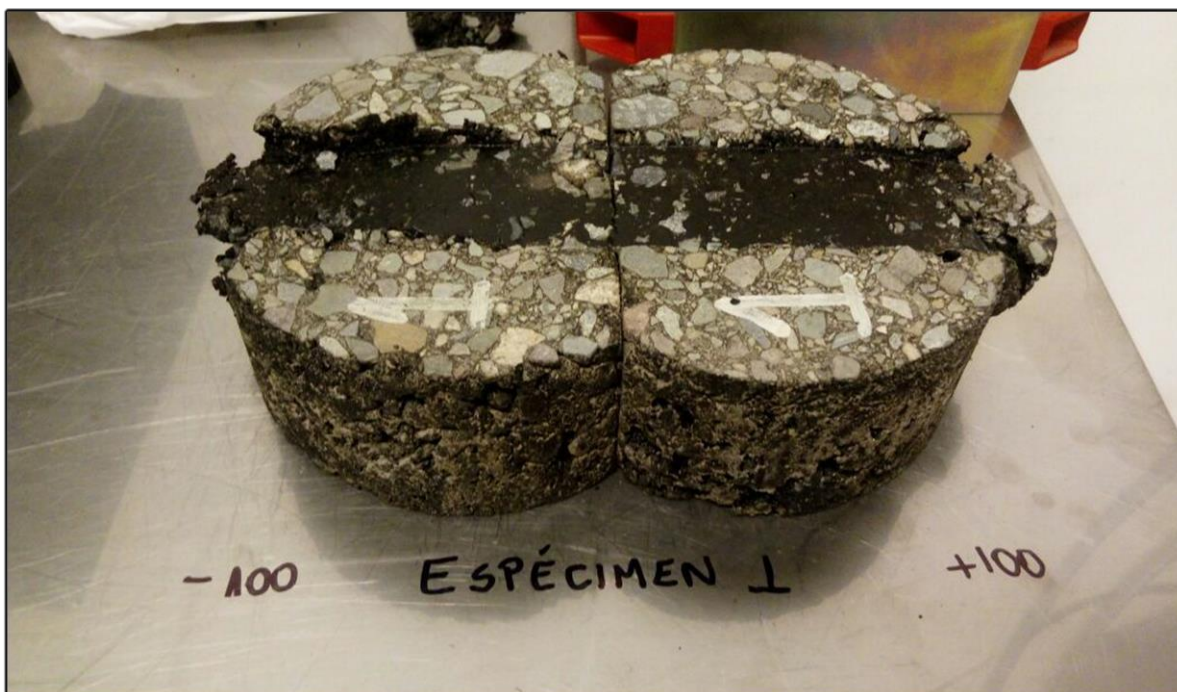
Imagen 6-17 Probeta 1 sometida a las ruedas de carga por la máquina de Hamburgo
