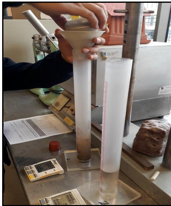
Imagen 6-8 Vertido de la muestra en las probetas de comparación
