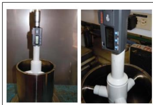
Imagen 3-2 Micrómetro con galga para medir diámetros internos [8]
