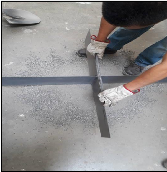
Imagen 6-3 Cuarteo manual del árido
