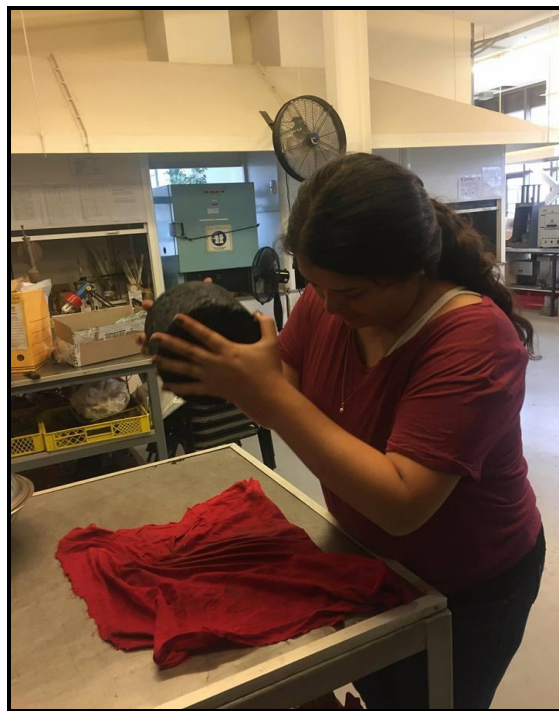
Imagen 6-15 Secado de la probeta en tela húmeda para conseguir condición SSD
