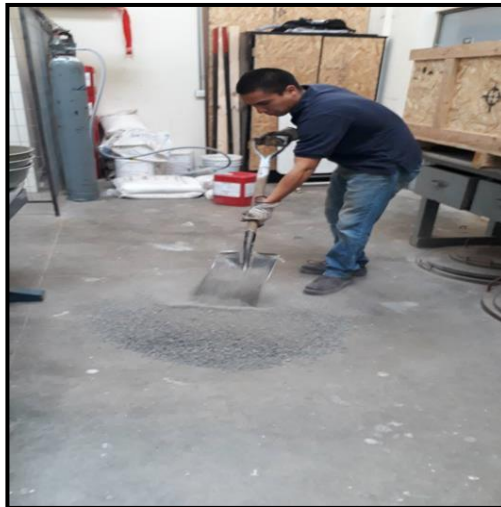
Imagen 6-2 Mezclado del árido previo al cuarteo
