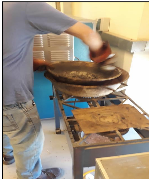
Imagen 6-12 Mezclado manual con poruña metálica sobre una cama de arena calentada en una cocinilla
