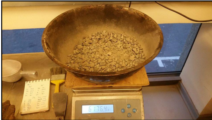
Imagen 6-11 Cuenco metálico con granulometría de prueba previo a la incorporación del asfalto
