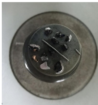
Figura 3.12. Muestra en prensa semiautomática antes de montaje
