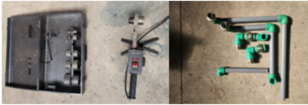
Figura 5.2: Imagen de termofusora ocupada para fusión de PPR y prearmado de línea de PPR.
