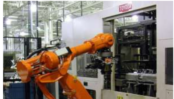
Imagen 7: BRAZO ROBOTICO USADO PARA SERVIR A UNA MÁQUINA DE PRODUCCIÓN TRANSFIRIENDO PIEZAS DESDE LAS MÁQUINAS. [FOTOGRAFIA]. Recuperado de http://roboticacamilacardenas.blogspot.cl
