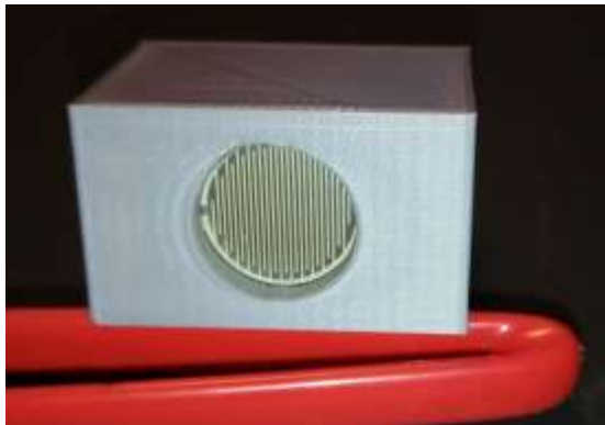
Imagen 99: VISTA FRONTAL DE LA MAQUETA TERMINADA Y EXTRAIDA DE LA IMPRESORA, DONDE SE APRECIA CLARAMENTE EL SENSOR INSERTO EN EL BLOQUE IMPRESO. [IMAGEN]
