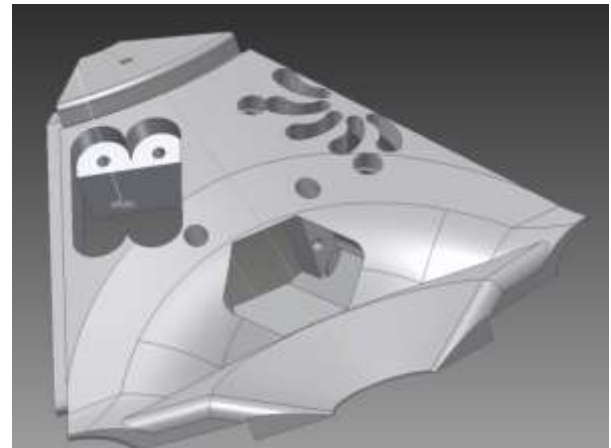
Imagen 78: MODULO CONSTRUCTOR DE LA CUBIERTA, DONDE SE APRECIAN CAVIDADES PARA EL ANCLAJE DE PUERTOS USB HEMBRAS (PARTE SUPERIOR IZQUIERDA DEL MODULO) Y LA CAVIDAD DE ANCLAJE PARA UN PUERTO RJ-45 HEMBRA. [IMAGEN]
