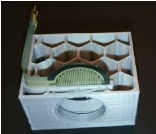
Imagen 98: INSERION DEL SENSOR DENTRO DE LA CAVIDAD UNA VEZ QUE SE REALIZA LA PAUSA PROGRAMADA. [IMAGEN]
