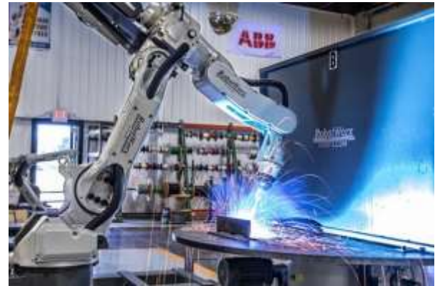
Imagen 5: BRAZO ROBOTICO REALIZANDO LABORES DE SOLDADO. [FOTOGRAFIA]. Recuperado de https://www.robots.com/applications
