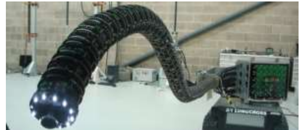
Imagen 10: MANIPULADOR CINEMÁTICO DISEÑADO PARA LA INSPECCIÓN DE TUBERÍAS DE ALTA RADIACIÓN. [FOTOGRAFÍA]. Recuperado de https://sites.google.com/site/tgadeadoc/3-tercera-unidad/d-uso-de-la-robotica
