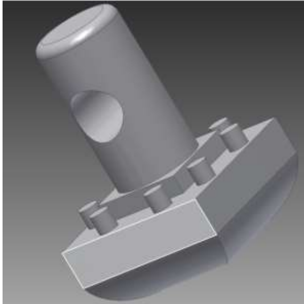
Imagen 74: CUERPO INTERNO DE LA BOTA, CONSTRUIDO DE ABS. [IMAGEN]
