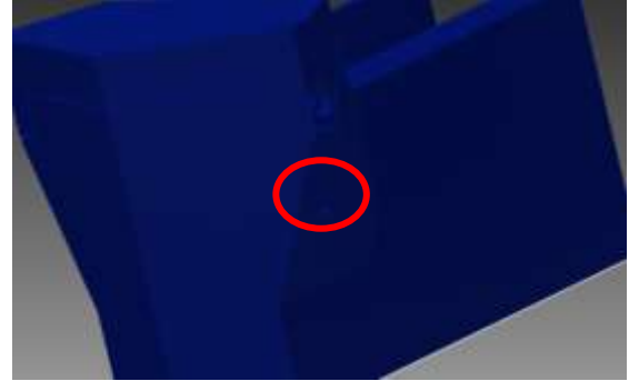
Imagen 53: PROTUBERANCIA SEMIESFERICA QUE PERMITE MANTENER EN SU LUGAR EL MODULO DE BATERIA. [IMAGEN]
