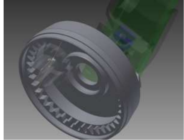
Imagen 90: SEGUNDA COMPONENTE MOVIL, CONTIENE UN ENGRANAJE PERIMETRAL COMO PARTE DE SU ESTRUCTURA Y UNA GUIA PARA MANTENERSE CENTRADA A LA COMPONENTE ESTÁTICA. [IMAGEN]
