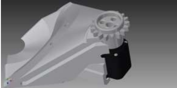
Imagen 83: MÓDULO DE CUBIERTA QUE SOPORTA EL SERVO ENCARGADO DE HACER GIRAR EL MECANISMO DE GIRO DE LA CÁMARA. [IMAGEN]
