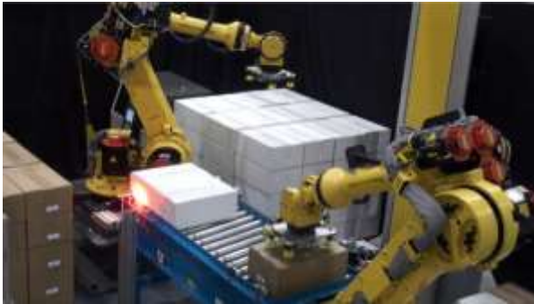
Imagen 6: “GAKUSHU” EL ROBOT QUE APRENDE, REALIZANDO TAREAS DE DESPLAZAMIENTO DE CARGA. [FOTOGRAFIA]. Recuperado de http://robot.fanucamerica.com/robotics-articles/industrial-robots-reducing-cycle-time.aspx
