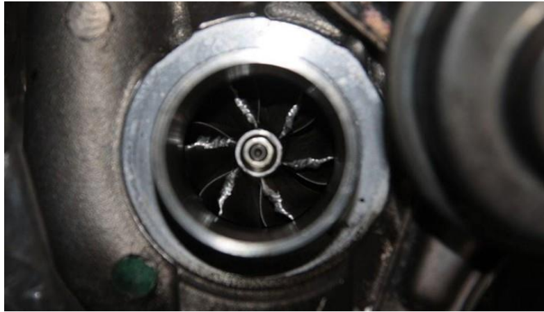
Figura 3.6: Turbo dañado por contaminación.
