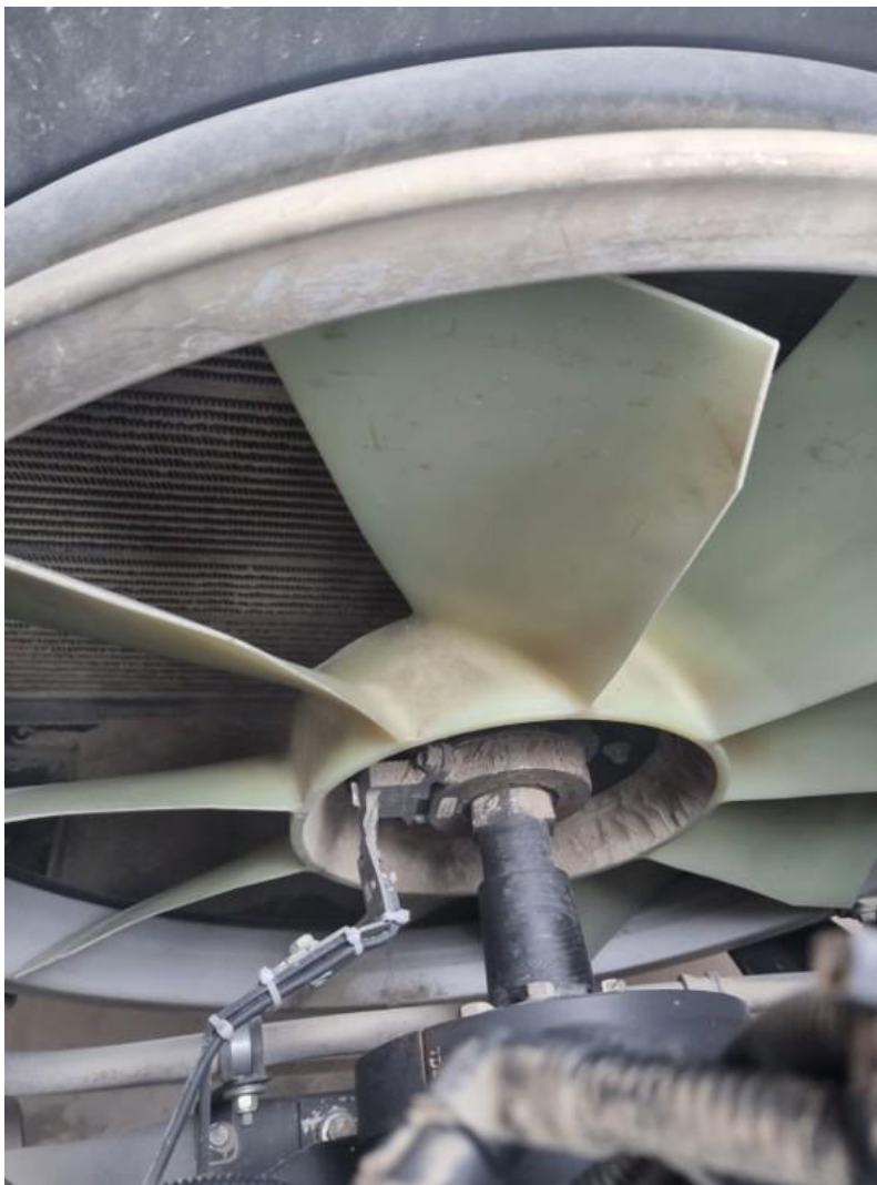
Figura 3.1: Embrague viscoso en operación.
