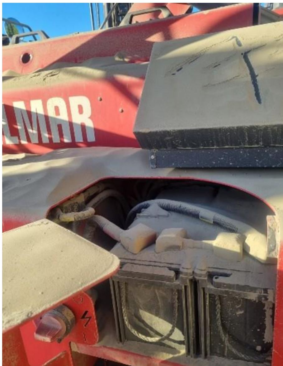
Figura 2.8: Equipo sin tapa inferior de motor del fabricante.
