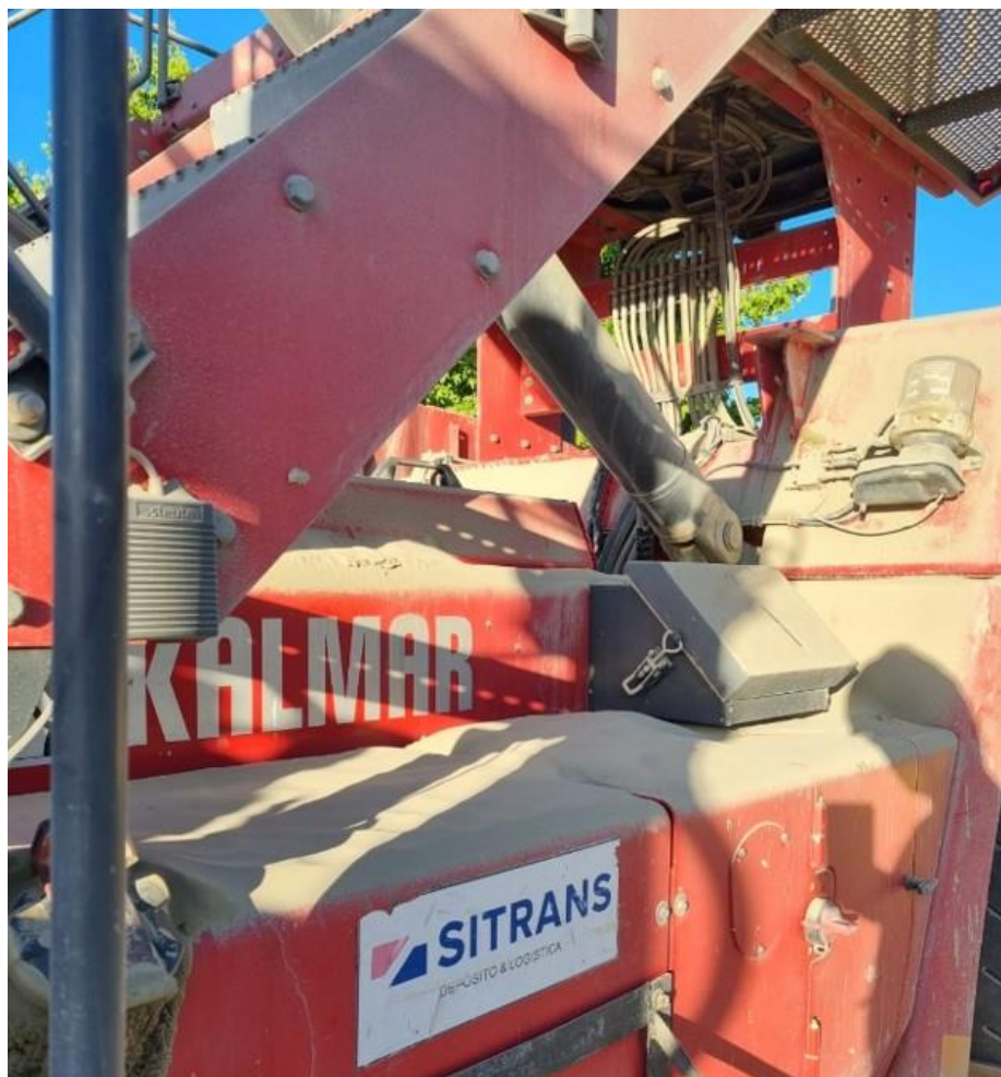
Figura 1.8: Toplifter DCG 80-90 sin tapa cubre motor inferior.
