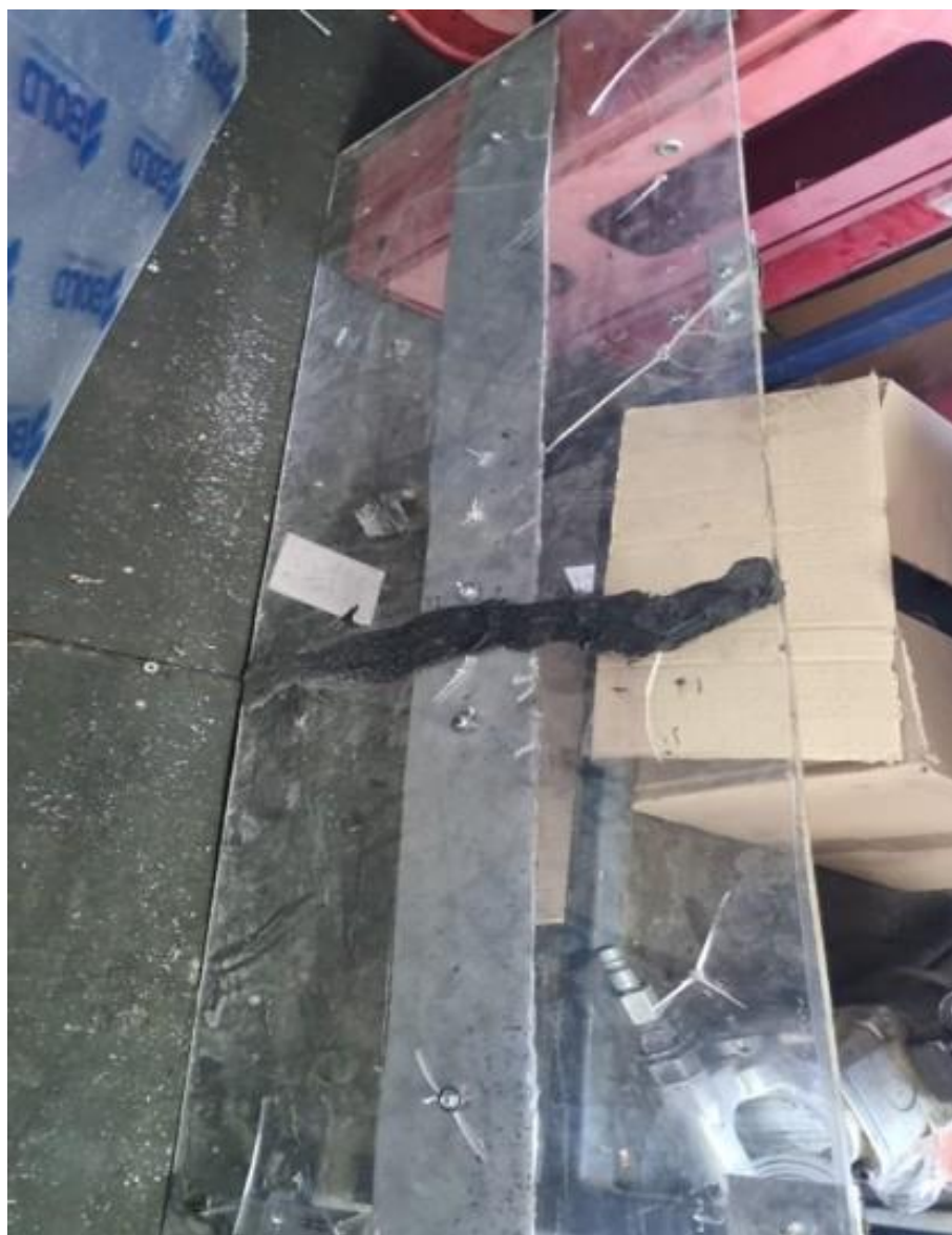
Figura 2.10: Tapa inferior de acrílico dañada por vibraciones.
