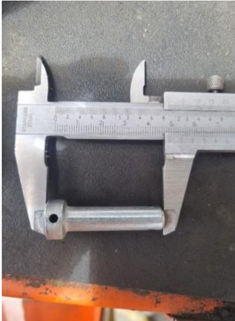
Figura 2.5: Medición del pasador de fijación.
