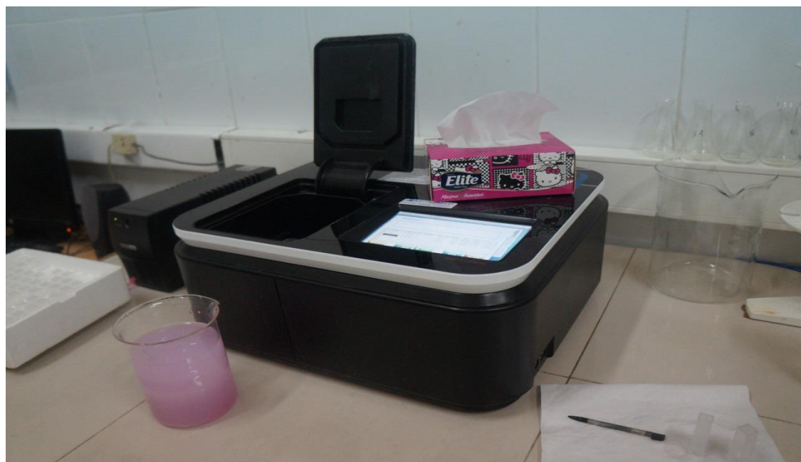
Figura 3.4: Espectrofotómetro utilizado para la medición de nitrato ( \text{NO}_3^- ), nitrito ( \text{NO}_2^- ) y sulfato ( \text{SO}_4^{2-} ).
