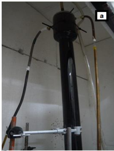
Figura 3.1: (a) Fotografía del reactor EGSB; (b) esquema del reactor EGSB [cm] utilizados en este estudio.
