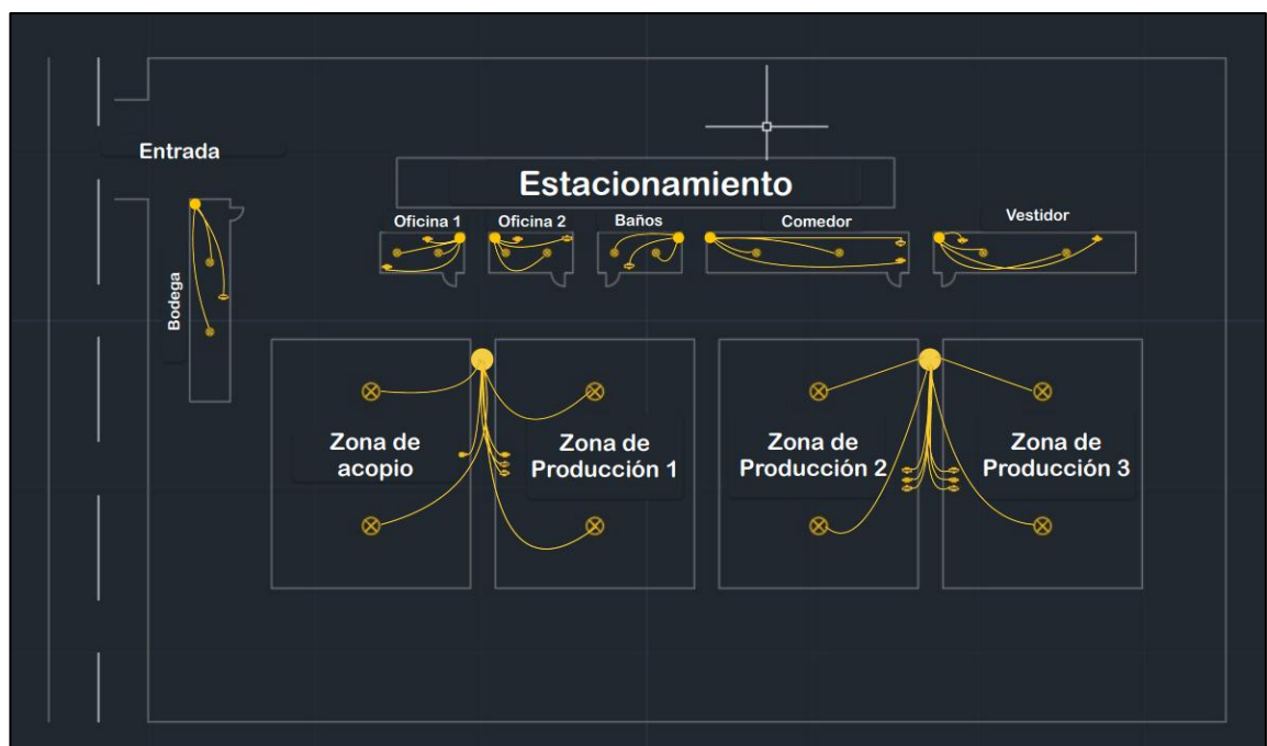
Figura 2-7. Plano Instalaciones Eléctricas.
