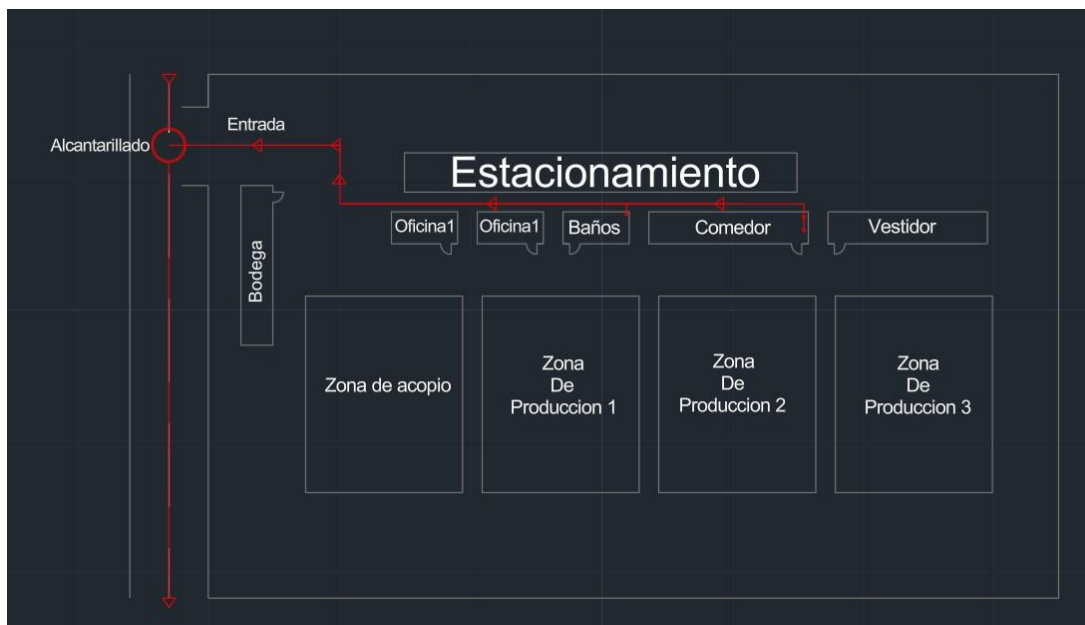
Figura 2-5. Plano de Alcantarillado
