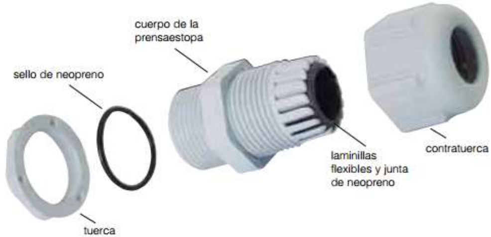
Figura A-5. Desglose de las piezas de una prensa estopa tipo
