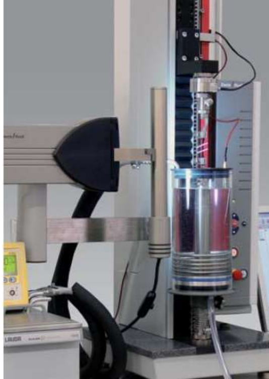
Figura A-3. Dispositivo de la línea médica Zwick para ensayos in vitro, con control de líquidos y temperatura.
