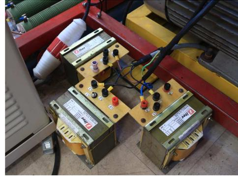
**Figura C.4:** Inductores usados en serie con el rotor para reducir el rizado debido a la baja inductancia de la DFIM.
