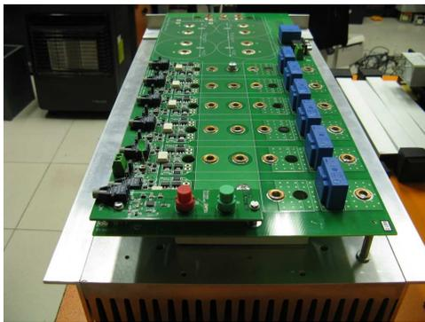
**Figura C.15:** Etapa de montaje del convertidor de seis piernas.
