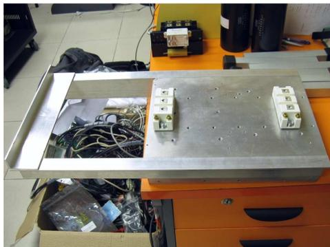
**Figura C.13:** Disipador térmico de aluminio usado como soporte mecánico del VSC.
