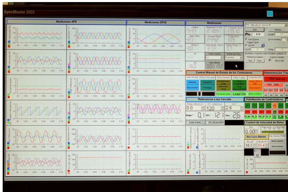
Figura C.11: Interface hombre-máquina diseñada en dSPACE para control, monitoreo y captura de datos.
