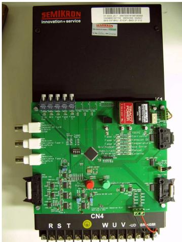
**Figura C.9:** VSC trifásico usado como RSC para alimentar el rotor de la DFIM.
