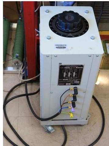
**Figura C.10:** Auto-transformador (variac) usado como transformador de adaptación de tensión con capacidad de conducir corrientes de modo común.
