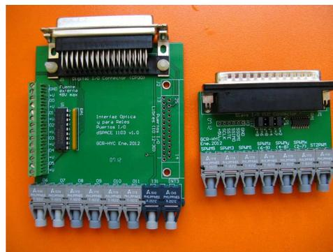
**Figura C.24:** Tarjetas de adaptación a fibra óptica para conector de IOs y PWM del dSPACE 1103.
