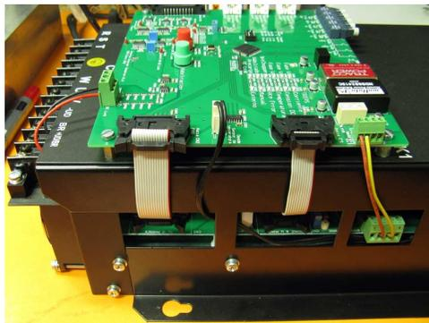
**Figura C.17:** Montaje de la tarjeta de intervención para el convertidor Semikron.
