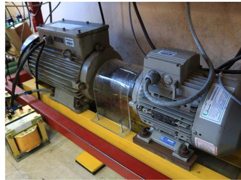
**Figura C.6:** Banco experimental de máquinas. A la izquierda la DFIM, a la derecha la IM jaula de ardilla.
