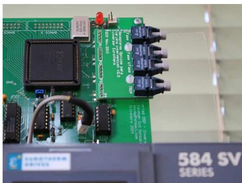
**Figura C.21:** Tarjeta de recepción óptica para la tarjeta de intervención del convertidor Eurotherm 584SV.
