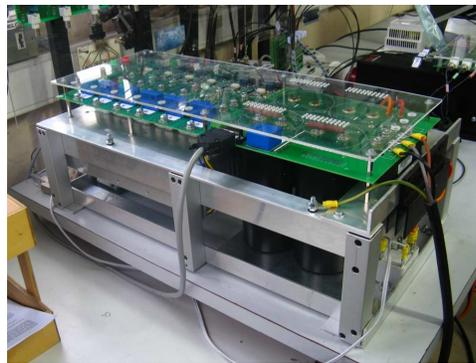
**Figura C.16:** VSC ya construido y listo para su operación.
