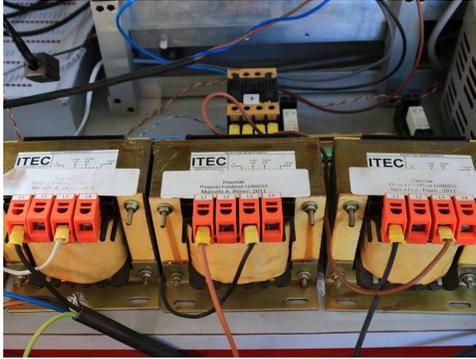
**Figura C.3:** Inductores usados como filtro de línea para el GSC.
