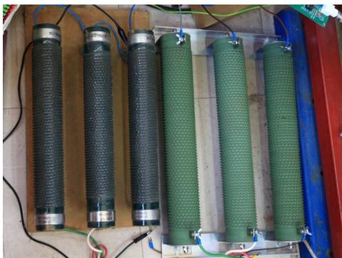
**Figura C.1:** Cargas resistivas trifásicas que permiten ensayar desequilibrios.
