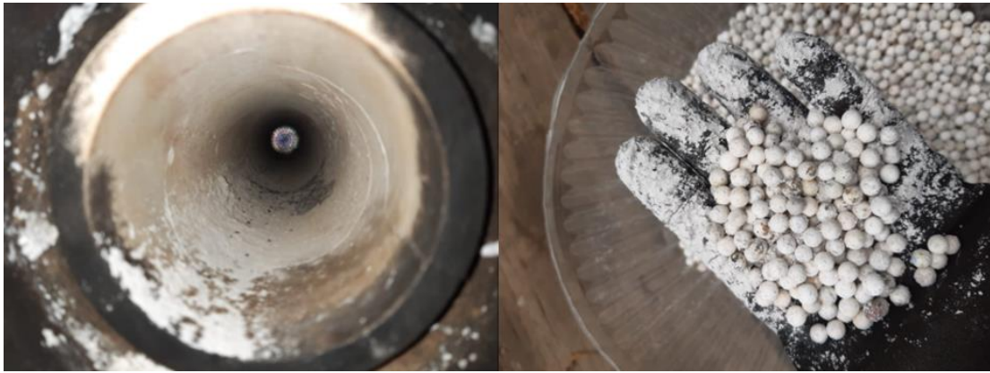
Figura 42: Cenizas presentes en las esferas y el interior del cilindro cerámico.
