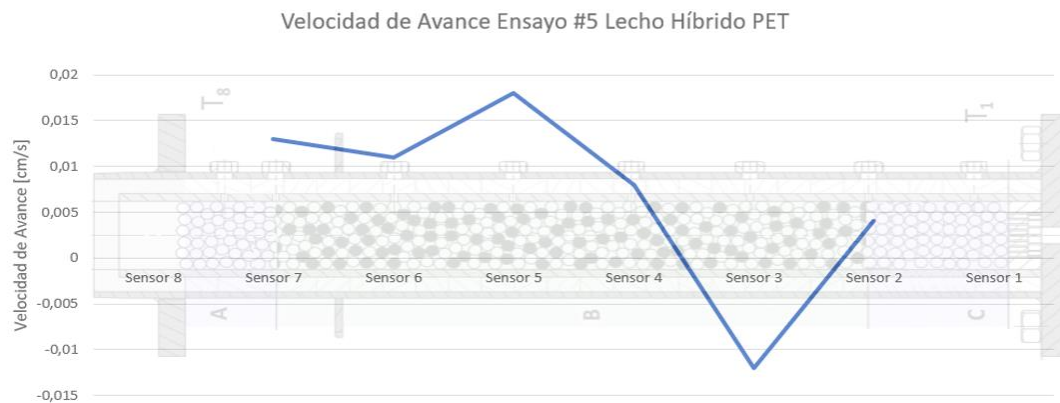
Gráfico 8: Velocidad frente de llama vs espacio ensayo #5.
