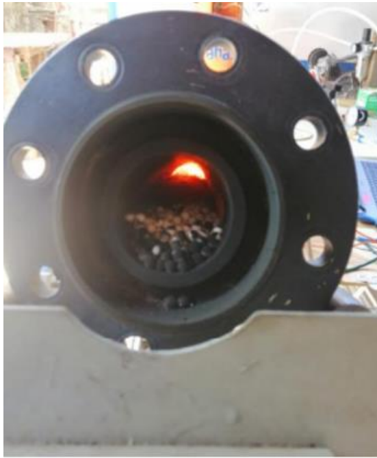
Figura 37: Perfil de media luna presente en el interior del gasificado, una vez gasificado el RSU.
