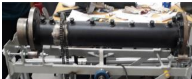
Figura 21: Cuerpo principal del gasificador prototipo.
