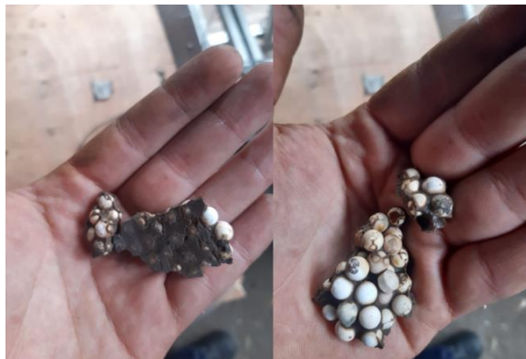
Figura 39: Masa café adheridas a esferas de alúmina durante ensayo estático de gasificación HDPE.
