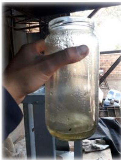
Figura 49: Condensado generado durante la gasificación.
