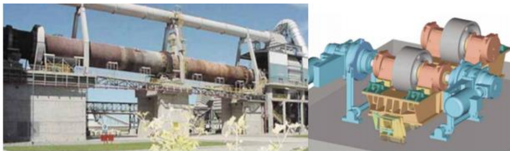
Figura 8: A la izquierda, se observa la instalación de un horno sobre 3 apoyos. A la derecha, se muestra un CAD de un conjunto de apoyos, con su respectivo motor de accionamiento [11].
