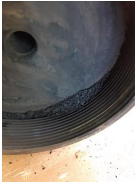
Figura 37: Perfil de media luna presente en el interior del gasificado, una vez gasificado el RSU.
