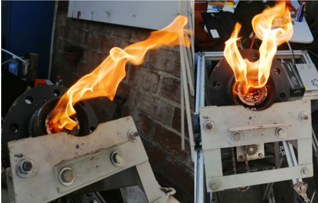
Figura 53: Llama proveniente desde el interior del gasificador, durante inyección de mezcla rica de combustible.
