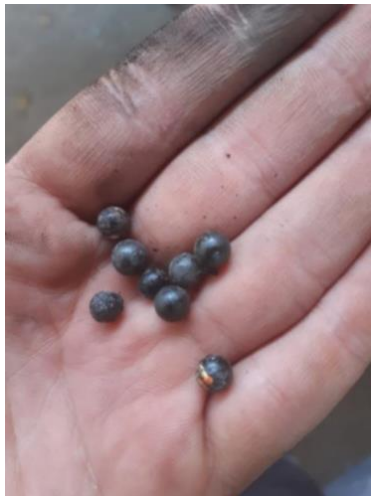
Figura 40: Esferas retiradas desde el interior del gasificador, recubiertas por una sustancia negra y brillante.
