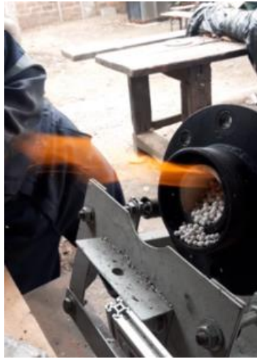
Figura 44: Llama que sale del interior del gasificador, durante gasificación de cartón.
