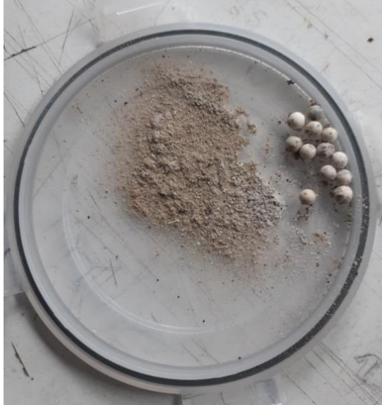
Figura 46: Ceniza presente en el interior del gasificador, luego de gasificar algodón.
