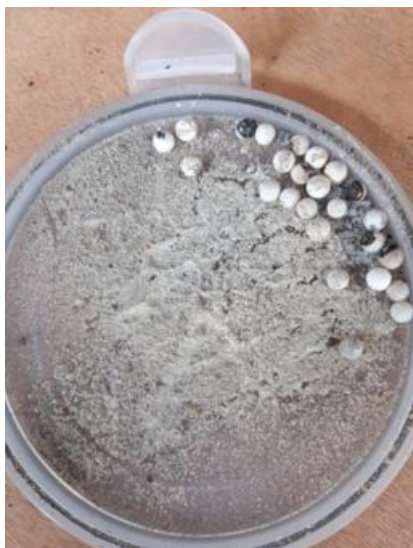
Figura 45: Ceniza retirada desde el interior del gasificador, luego de gasificar cartón.
