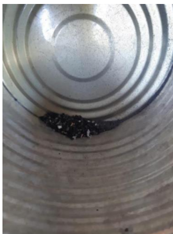
Figura 41: Ceniza negra retirada desde el interior del gasificador.
