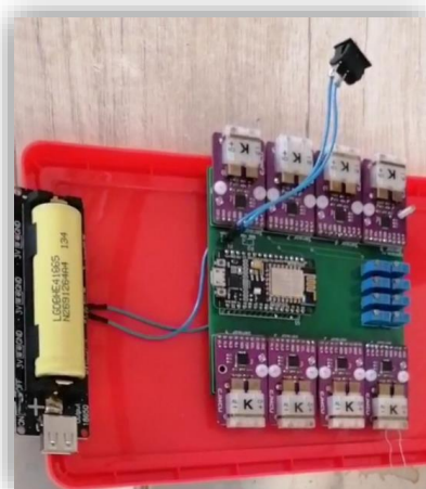
Figura 25: Módulo inalámbrico con sus respectivos sensores y batería del conjunto.
