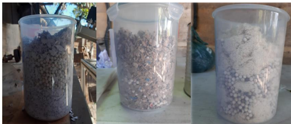
Figura 33: Mezclas heterogéneas de papel, cartón y algodón con esferas de alúmina.
