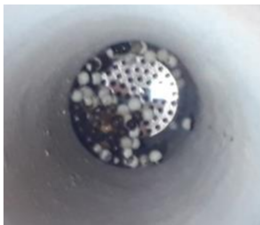
Figura 50: Esferas pegadas en la pared del cilindro cerámico, luego de la gasificación de PET con rotación.
