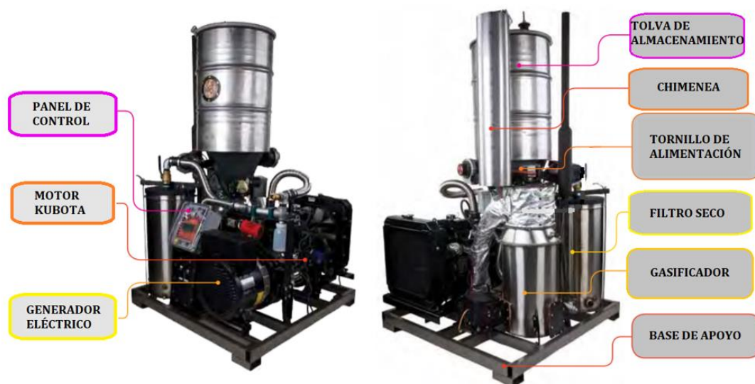
Figura 51: Desglose de partes de unidad GEK
