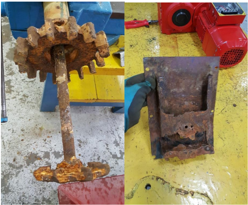
Figura 2- 8 Agitador y Tapa de Celda de Flotación Deterioradas
