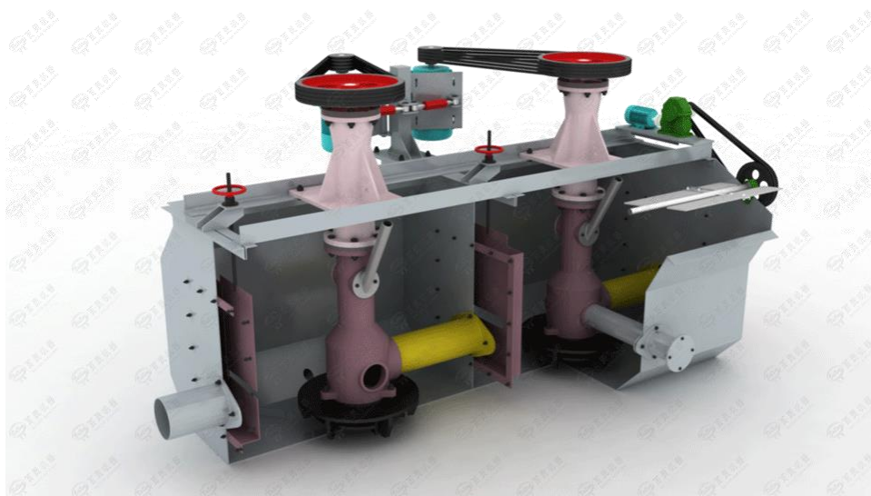
Figura 1- 2 Celda de Flotación "Sub-A"
