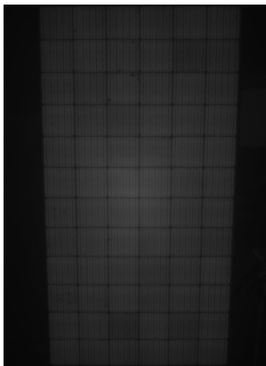
Figura XLIX. Módulo en oscuridad y con inducción de corriente I_{sc} . Parámetros: ISO 100 - Apertura f/5 - Tiempo de Exposición 60 segundos.
