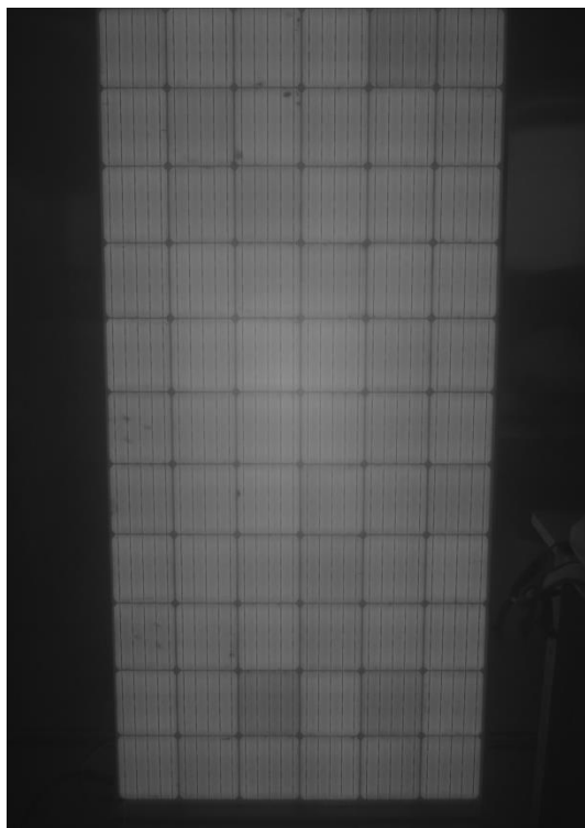
Figura L. Módulo en oscuridad y con inducción de corriente I_{sc} . Parámetros: ISO 500 - Apertura f/5 - Tiempo de Exposición 25 segundos.
