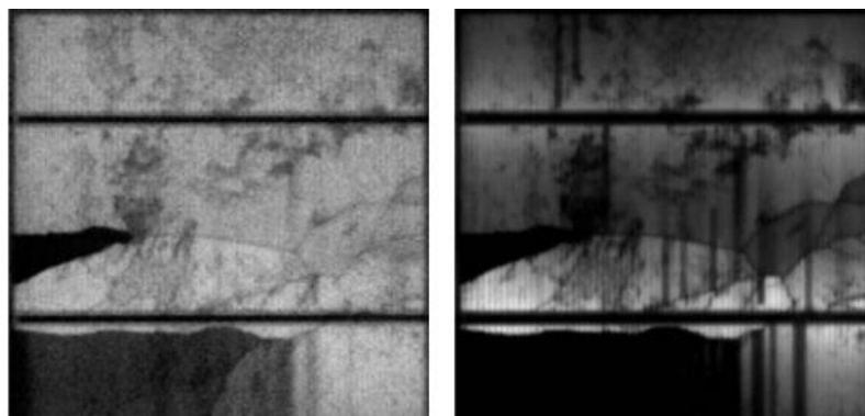
Figura XIII. Captura EL de Celdas con Cracking Tipo C, sometidas a corrientes de 10% de la I_{sc} (izquierda) e I_{sc} (derecha) (International Energy Agency, 2014).
