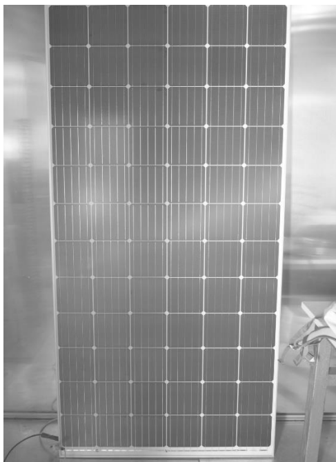
Figura XLVIII. Captura de módulo bajo luz natural (escala de grises), en ambiente interior oscuro, pero con puerta abierta.
