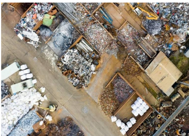
Ilustración 13: segregación de residuos en obra.
