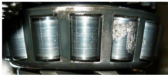
Figura 2.3. Rodamiento sobrecalentado por falta de lubricación. Fuente: blogmecanicos.com
