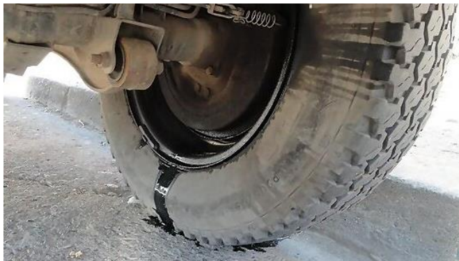
Figura 2.1. Punta de eje con pérdida de lubricante. Fuente: lucas/m.foros.com
