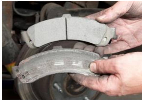
Figura 2.11. Comparación pastilla nueva y usada. Fuente: herramientasdetaller.es
