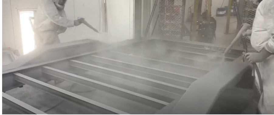
Figura 2.17. Proceso de aplicación del polvo. Fuente: diamondc.com
