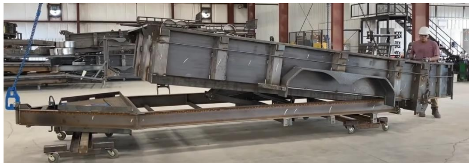
Figura 2.16. Bastidor entrando a la cadena de imprimación. Fuente: diamondc.com
