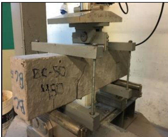
Ilustración N°11: Ensayo al corte diagonal (LEMCO UTFSM, Chile).
