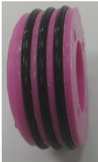
Imagen 36 – Pieza S-3 donde podemos notar la misma geometría para los tornillos que en la pieza S-2, y los O’Ring necesarios para empujar el material de forma óptima.
