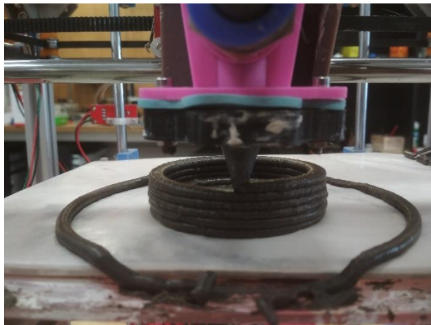
Imagen 60 - Impresión 3D de BioCompuestos en base a cenizas de madera.
