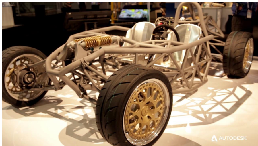
Imagen 9 – Chasis de un auto diseñado a través de software de diseño generativo de Autodesk.
