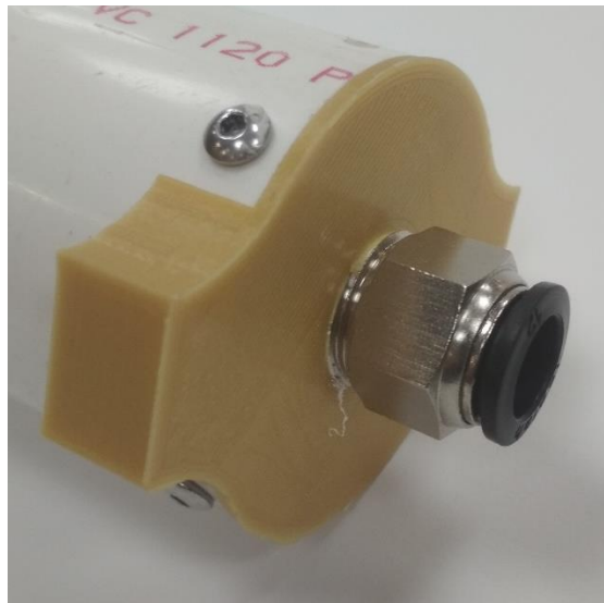
Imagen 38 – Pieza S-7 y su relación con el Tubo de PVC y el conector fitting neumático.
