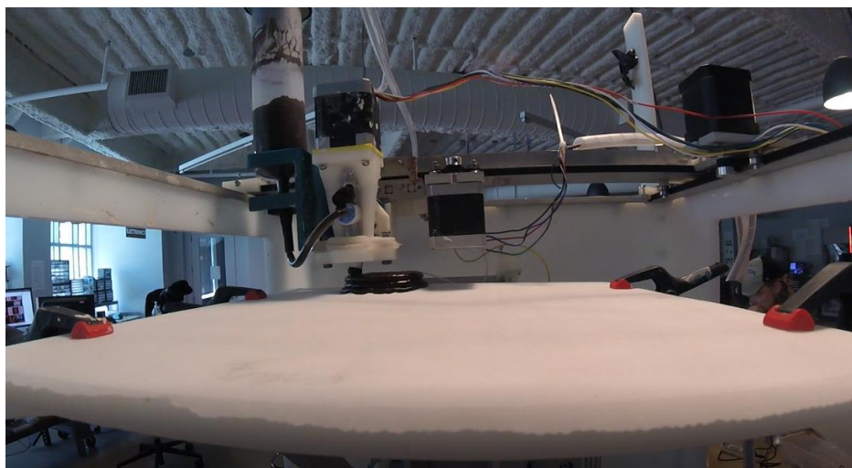
Imagen 63 - Sistema de impresión 3D implementado en una máquina ClayStack.
