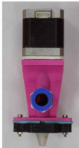
Imagen 55 – Sistema de extrusión indirecto basado en Auger Screw .
