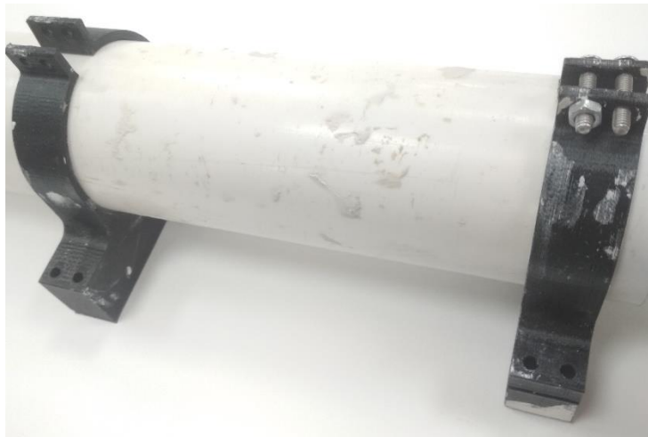
Imagen 37 – Piezas S-5 y S-6 con el tubo de PVC donde se almacenará el material.
