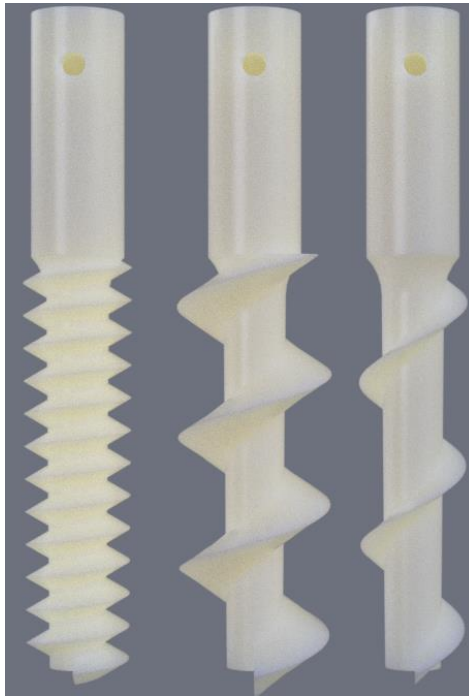
Imagen 41 – 3 versiones distintas del Auger Screw para los que se varió algún parámetro.
