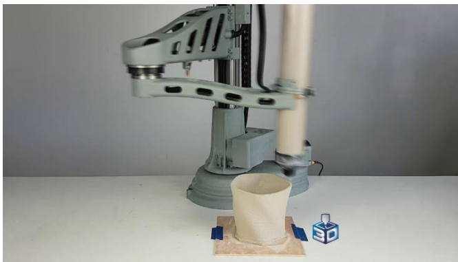
Imagen 18 y 22 – Ejemplos de robots SCARA utilizados en la impresión 3D de materiales viscosos (Plotter, s.f.).
