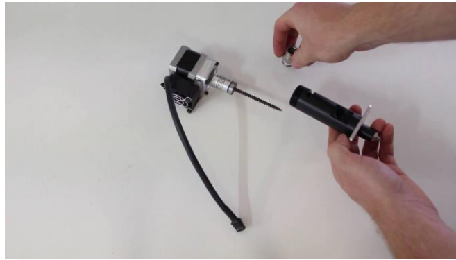
Imagen 13 – Extrusor indirecto basado en una Bomba de Arquímedes desarrollado por la empresa Wasp (Moretti, 2016).
