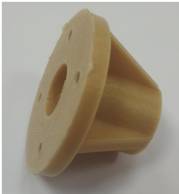
Imagen 35 – Pieza S-2, donde podemos notar la perforación para que pase el husillo de bolas, y los tornillos que la unirán con la pieza S-3.
