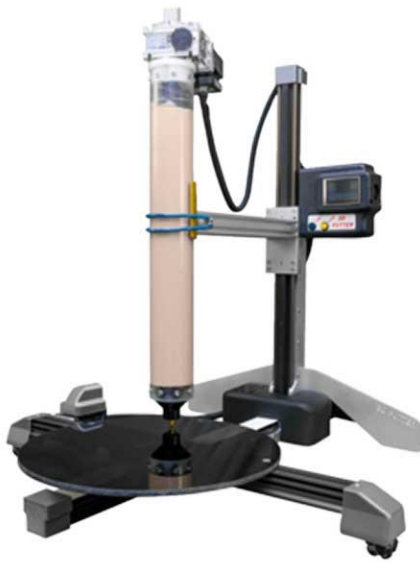
Imagen 25 – Impresora 3D de cerámica con un sistema SCARA de base móvil desarrollada por la empresa Delta Bots (Delta Bots , s.f.).
