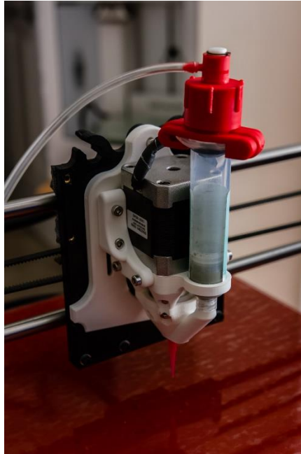
Imagen 14 – Diseño de un sistema que combina una jeringa neumática y un auger screw desarrollada por Kevin Lee para extruir pasta de soldar (Lee, 2015).
