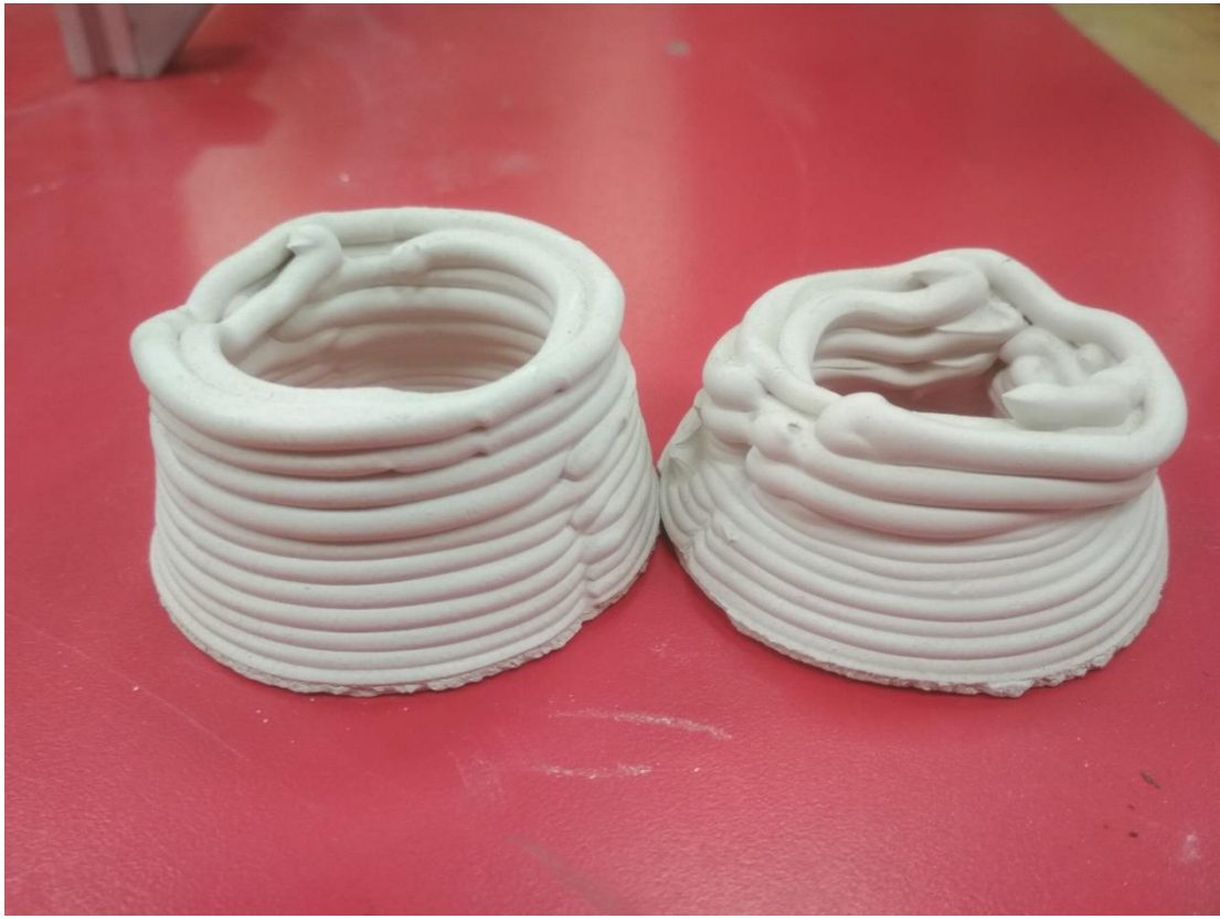
Imagen 46 – Diferencia entre las impresiones utilizando el sistema de alimentación neumático con PID (izquierda) y sin PID (derecha).
