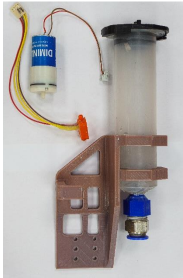
Imagen 56 – Sistema de alimentación neumático.
