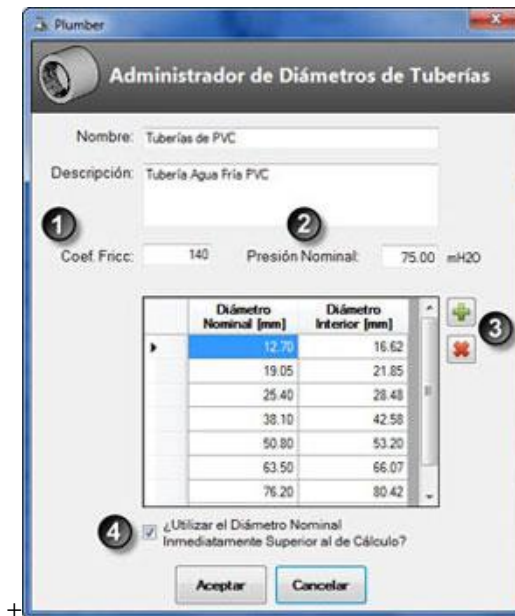
Img. 15:Administrador de Diámetros de Tuberías
