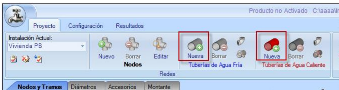
Img. 21: Comando "Nueva Tubería"
