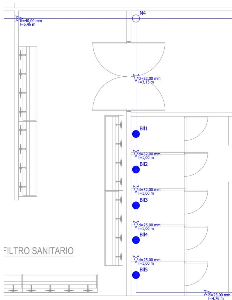
Img. 50: Instalación de agua potable fría (Plumber) – planta alta oficinas Andinexia
