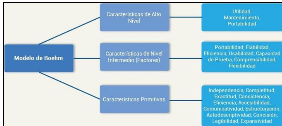
Figura 2: Esquema general del modelo de Boehm
