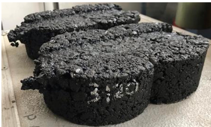
Imagen 16 - Resultado del ensayo de ahuellamiento de briquetas 120 y 121.
